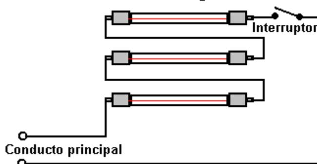
Si el calentador halógeno ahora está conectado a través de 700 voltios, el resultado es que si las bombillas halógenas son similares entre sí, entonces alrededor de un tercio de los 700 voltios estará en cada bombilla. Esta es solo una sugerencia no probada, aunque un calentador de este tipo funciona bien con una potencia baja de 220 voltios, pero proporciona una carga resistiva de alto voltaje como punto de partida para la experimentación.
