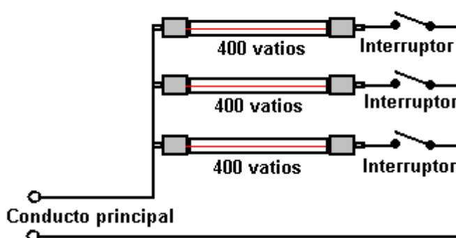
Puede cambiar el cableado dentro del calentador, de modo que las tres lámparas halógenas estén conectadas en una cadena. Como los cables que se conectan a las lámparas a menudo tienen conectores de "pala" que se insertan para permitir la fabricación simple y el reemplazo fácil de una lámpara halógena, esto puede hacerse sin necesidad de soldadura. El nuevo arreglo es así:
