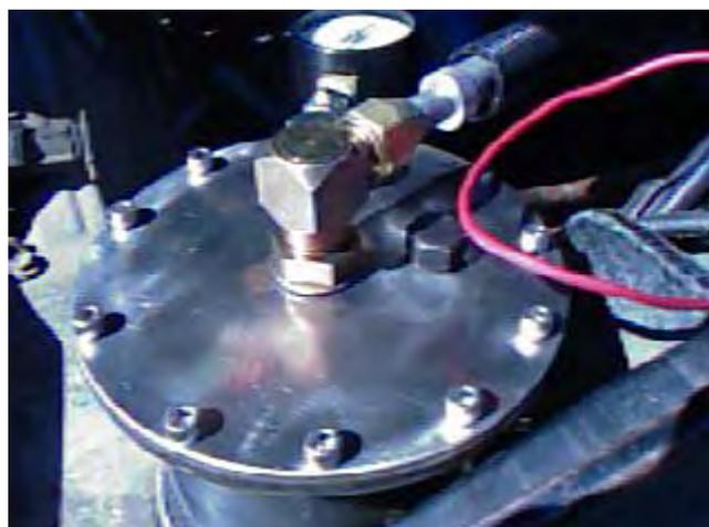
Крышка может быть отделана путем сверления ее центра, чтобы получить фитинг для алюминиевой трубы, который будет подавать выходной сигнал от ячейки к двигателю. Этот фитинг, как и любой другой фитинг, должен быть изготовлен из нержавеющей стали. Видео на <http://youtu.be/-7075bVmDQo>.
