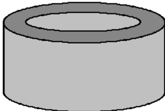
Затем этот сердечник наматывается толстым проводом - возможно, AWG № 10 или 12 SWG (квадратный провод 2,3 x 2,3 мм). Повороты проволоки должны быть плотно прилегающими друг к другу и располагаться ровно на верхней поверхности, так как проволока там будет соприкасаться с помощью скользящей щётки:
