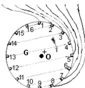
Пунктирные линии обозначают внутренние электрические соединения, поэтому например, контакт 14 подключен к контакту 3, но позвольте мне еще раз подчеркнуть, что это устройство **не** является частью конструкции и хотя оно используется для «объяснения» фактической работы, я бы не стал удивляться, если бы это не было предназначено, чтобы дезинформировать людей по поводу фактической операции.
