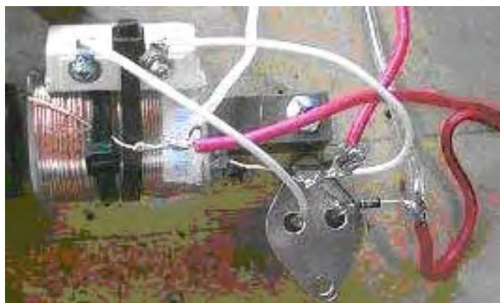
Come si può vedere, il trucco è quello di posizionare il commutatore in modo che corre lungo la lunghezza della bobina e quindi si trova nel campo magnetico della bobina. Questo coppie campo magnetico della bobina Commutatore nonché il campo magnetico del magnete del rotore passa. Questo fornisce una retroazione magnetico e trasforma il commutatore in un oscillatore. Così, quando il
