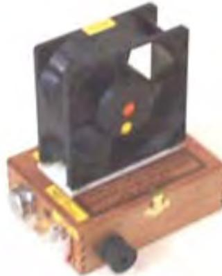
Questo apparecchio funziona con una batteria PP3 9V come batteria di alimentazione, e carica una batteria ricaricabile PP3 9V quando è in esecuzione. Entrambe le batterie sono racchiuse nel box in questa costruzione molto ordinato.
