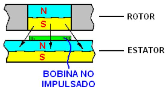
Cuando la bobina no tiene corriente que fluya a través de ella, no produce un campo magnético y el polo sur del imán del rotor es atraído con igual fuerza hacia delante y hacia atrás por el polo norte del imán del estator. Si hay dos bobinas, como se muestra a continuación, y se alimenta una y la otra no está accionado, el tirón hacia atrás se cancela y la atracción hacia adelante hace que el rotor se mueva hacia adelante:
