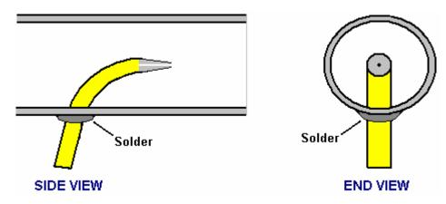
THE WAY THAT THE SILVER SOLDER PLUG IS MADE IS TO BLOCK THE END OF THE TUBE AND FILL THE TUBE WITH FINE GRAIN SAND BEFORE APPLYING THE SOLDER :
