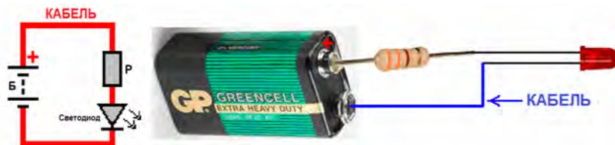
Если светодиод подключен неправильно, он ничего не повредит, но светодиод не загорится. Соединения плохого качества могут быть сделаны путем скручивания проводов. Более качественные соединения могут быть выполнены с помощью винтовых соединителей:
