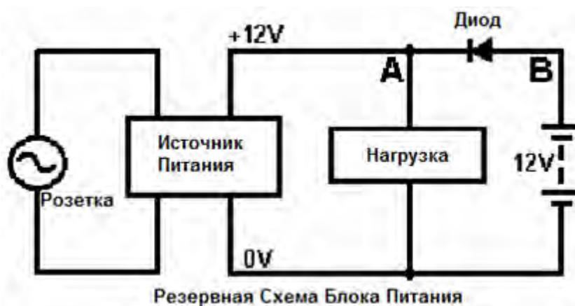
В этой цепи напряжение сети приводит в действие блок питания, который генерирует 12 вольт в точке «А». Это обеспечивает ток для нагрузки. Диод имеет +12 Вольт при «А» и +12 Вольт в точке «В», поэтому на нем нет падения напряжения, и он не будет передавать ток ни в одном из направлений. Это означает, что батарея эффективно изолирована, когда сеть работает. Если бы выход блока питания превысил проектный уровень +12 Вольт, то диод заблокировал бы его от подачи тока в батарею.
