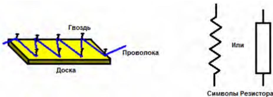
При рисовании принципиальной схемы исследователь нарисует на доске провод, дающий зигзагообразную линию, которая до сих пор используется для обозначения «резистора», хотя в настоящее время используются другие методы построения. Альтернативным символом для резистора является простой прямоугольник, как показано выше
