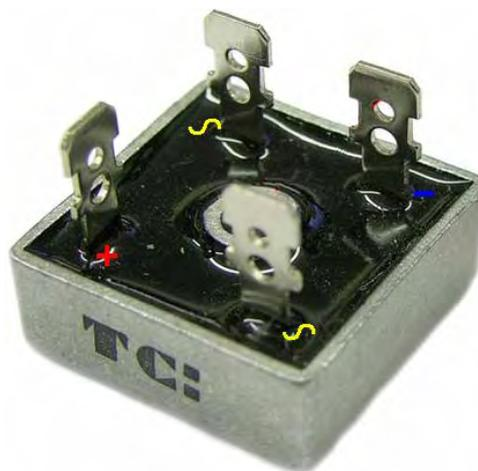
Переменный сигнал подается между двумя противоположными углами, а пульсирующий постоянный ток снимается с двух других клемм. Символы, показанные выше, обычно отмечены на плоской поверхности, которая не видна на этом рисунке. Упаковка имеет отверстие в центре, чтобы металлический корпус можно было прикрепить болтами к радиатору, чтобы устройство оставалось достаточно холодным при наличии больших токов. Соединения внутри пакета такие:
