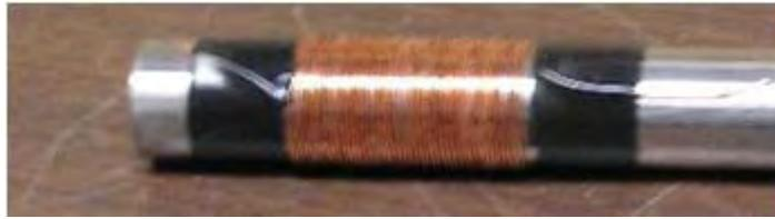
El alambre para la segunda capa es cortado a una longitud de 396 centímetros. Esta segunda capa de bobina será más larga que la primera capa, entonces antes de girarlo, es necesario aumentar el área a ambos finales de la primera capa con la cinta:
