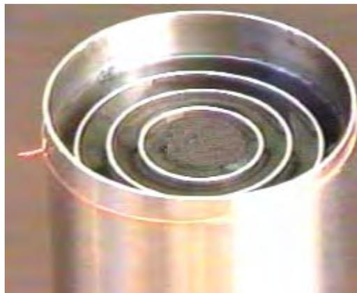
El cuadro sobre las muestras la construcción general de una célula de este tipo aunque, diferente la descripción debajo de, este uno no tiene el labio que se usa por atar la tapa. Es incluido aquí así como una ilustración general de cómo los cilindros se posicionan relativo a nosotros.
