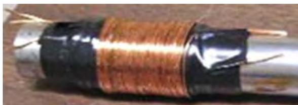
Para estar seguro que las segundas y terceras capas son centradas sobre las capas más tempranas, esto es una idea buena de localizar el centro del alambre y comenzar a serpentear a partir del medio hacia fuera en ambas direcciones:
