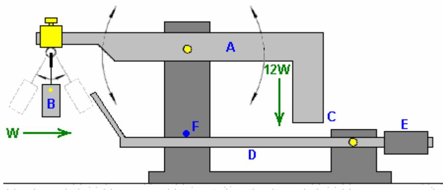
Aquí, la viga principal UN, es precisamente equilibrado cuando pesa B está colgando inmóvil en él es “el a-resto” la posición. Cuando pesa B es el balanceo fijo, causa la viga UN para oscilar, proporcionando el poder muy mayor al punto C debido a la masa muy mayor de viga A. Si una viga adicional, ligera D se proporciona y contrapesó por el peso E, para que tenga una presión ascendente muy ligera en su parada de movimiento F, entonces el funcionamiento debe ser auto-suficiente.
