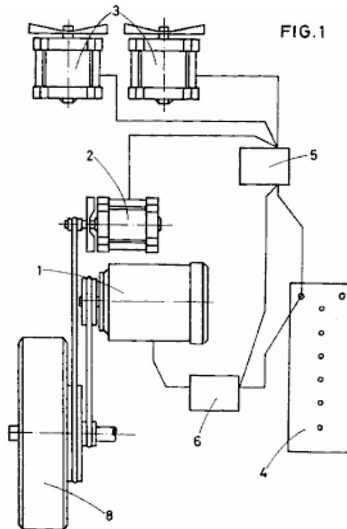
El motor eléctrico de tracción (1), es el componente encargado de suministrar al equipo la fuerza electromotriz necesaria para el funcionamiento del mismo; la potencia y tensión estará determinada por su utilidad en el sistema al que se desee aplicar.
