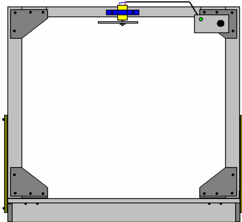
Debe explicarse que, a excepción del tablón grueso de 25 mm, todos de esta construcción es sólo cargada muy ligeramente como girar la parte superior del eje eje no toma mucha energía o esfuerzo en absoluto. Casi todo el peso giratorio está situado en la parte inferior del eje del árbol y ese peso descansa sobre algún tipo de cojinete que descansa en el medio de la tabla de 25 mm.
