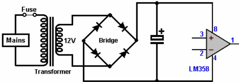
Si el voltaje en el pin 3 excede el voltaje en el pin 2, entonces la salida en el pin 1 será alta (aproximadamente 10 voltios); de lo contrario, el voltaje en el pin 1 será bajo. Nosotros usaremos el alto voltaje en el pin 1 para encender una de las válvulas y usaremos un transistor de alta ganancia de alta potencia como el TIP132 para hacer esto:
