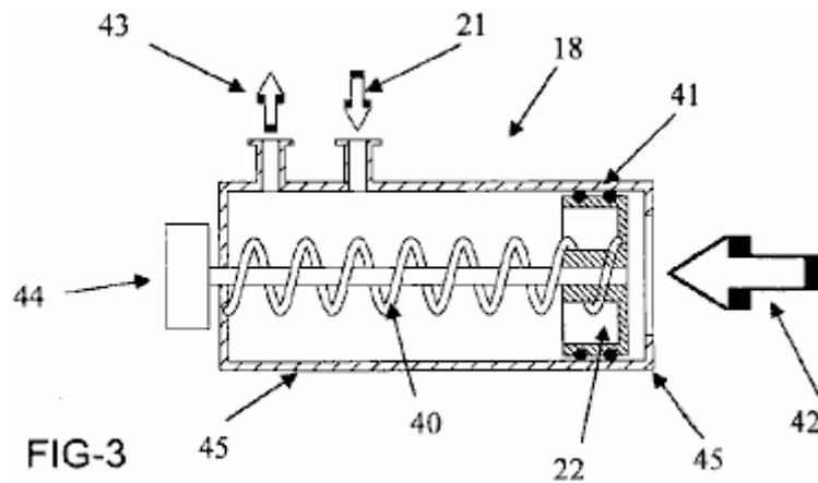
**Fig.3** muestra una versión de primer depósito de aire **18**. Aire se dibuja en depósito **18** a través de la toma de aire **21**. La reserva incluye un pistón **22** asociado con un resorte **40**, el pistón **22** contar con sellos **41** para evitar fugas de aire.
