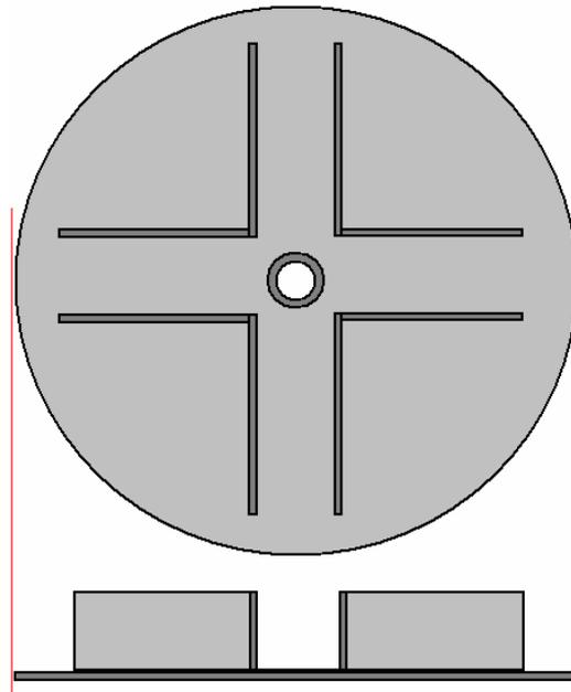
Como el diámetro del tambor es de 450 mm y se dejan 150 mm alrededor del centro y se dejan 50 mm en cada lado, las ocho paredes internas solo deben tener una longitud de  $225 - 75 - 50 = 100$  mm (6 pulgadas), lo que significa que se puede cortar desde la tira de 150 mm de ancho, utilizando el ancho de la tira como la longitud de cada una de las ocho tiras.
