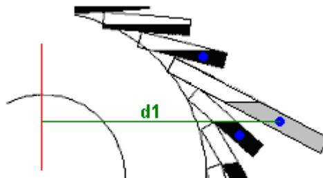
Sólo mediante el alargamiento del tubo, hay un aumento importante en el movimiento del líquido lejos del eje. El aumento de la longitud del tubo no tiene ningún efecto apreciable en el lado ascendente de la rueda.
