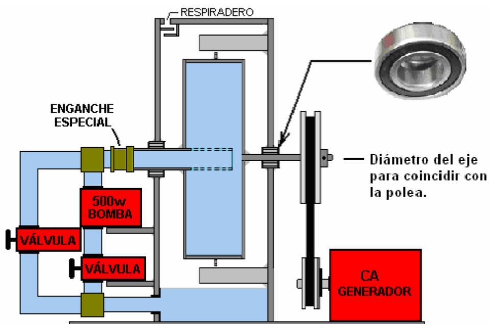
Si bien esto requiere una tubería adicional, una válvula y dos uniones en T para la derivación de la tubería, se obtiene una bomba que se puede apagar cuando no se necesita y la nueva válvula se utiliza como control de velocidad del tambor.
