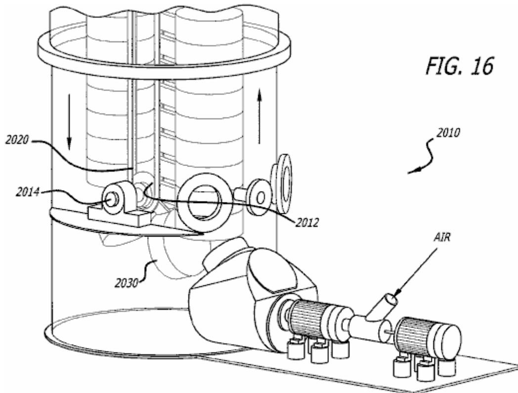
Como se muestra en **Fig.16**, cubos **2030** descienden en una cadena continua **2020** que pasa alrededor de un inferior y una superior rueda o polea. Al llegar a la polea inferior, los cubos giren alrededor de la polea inferior **2014** y otra vez en línea en el lado ascendente de la cadena. Inmediatamente después de dar vuelta alrededor de la polea inferior, cada cubo recibe el creciente flujo de aire.
