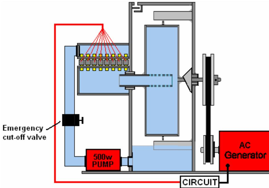
Con esta disposición, si la correa de transmisión se rompiera o el alternador desarrollara una falla grave, la tensión del circuito disminuiría y, como resultado, el circuito ya no suministraría corriente a las válvulas abiertas y todas se cerrarían. apagar el generador que es exactamente lo que se necesita.
