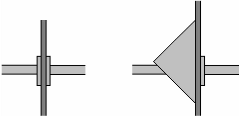
Para esto, dos triángulos de acero se cortan y se sueldan para que la mayor parte del petróleo que caiga sobre ellos se escurra sin alcanzar el cojinete:
