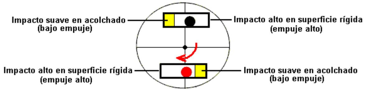
Cuando el disco rueda, la pelota se cae la longitud del tubo. A un extremo, el tubo tiene una gorra rígida que causa un impacto significativo cuando la pelota lo pega. El otro extremo del tubo está relleno y eso pone cojines en el impacto que causa un desequilibrio neto en los impactos y eso mantiene la rotación.
