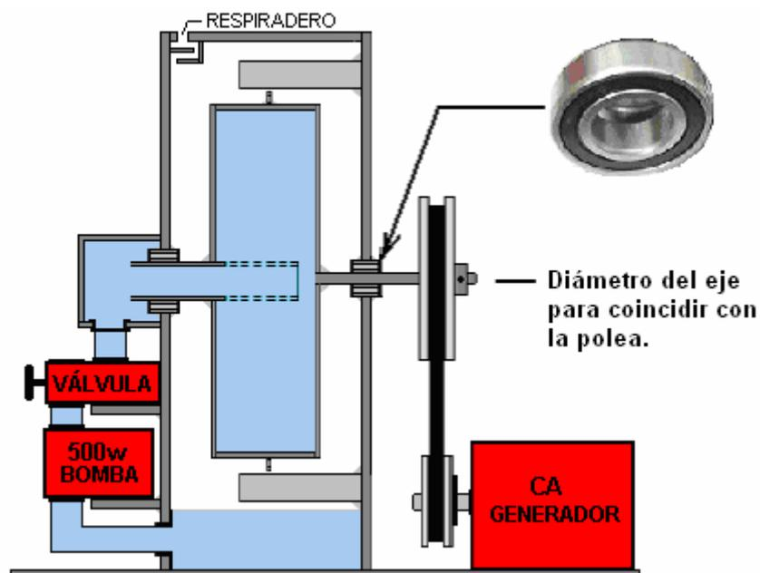
Con esta disposición, la válvula aún se usa para controlar la velocidad de rotación del tambor y si el rodamiento de 3 pulgadas de diámetro que soporta el lado de admisión del tambor pierde algo, entonces el exceso de líquido simplemente se derrama en el sumidero donde se encuentra. En primer lugar vino de Permítanme enfatizar que esto es solo una sugerencia en este momento dado que este acuerdo aún no se ha construido y probado.
