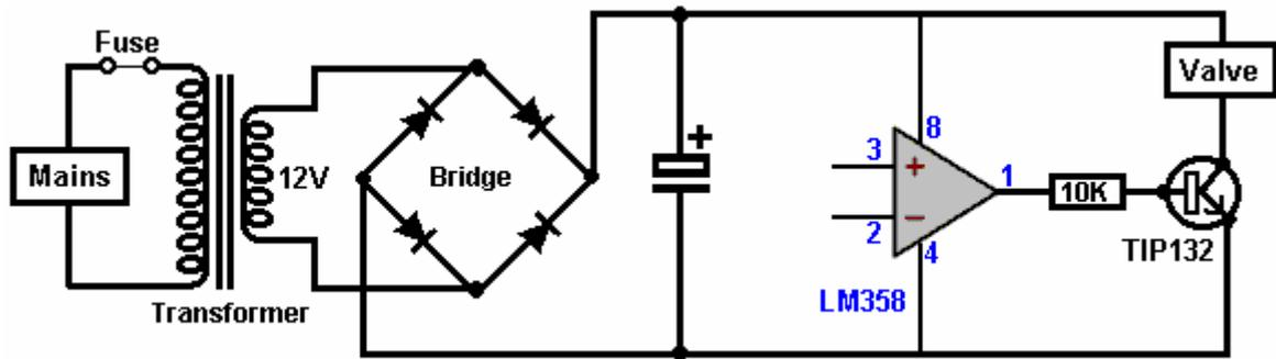
Cómo necesitamos que el LM358 se apague, lo que causa que el voltaje en el pin 1 descienda, privando al TIP132 de la corriente base y cortando la energía de la bobina de la válvula. Para eso, necesitamos que el voltaje en el pin 2 aumente por encima del voltaje en el pin 3 y queremos que eso suceda si el voltaje de la fuente de alimentación aumenta.
