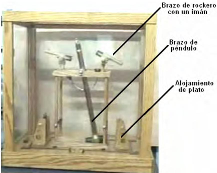
El dispositivo opera así: El péndulo gira al derecho y como él hace para que, levanta un imán atado al árbol del péndulo por un brazo color de plata encorvado:
