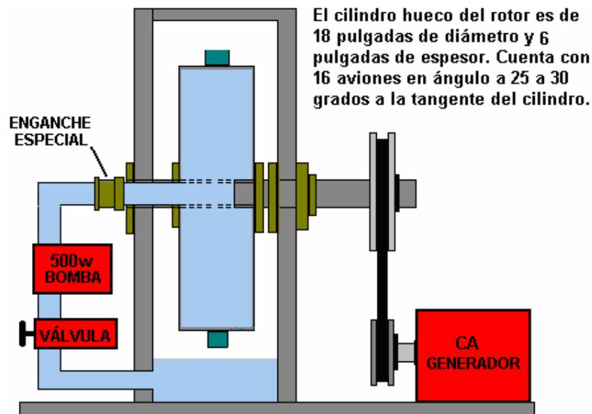
La mayoría de los generadores deben girar a 3000 rpm o ligeramente más rápido. Esa velocidad se puede lograr mediante el engranaje de la correa entre el eje de salida y el eje de entrada del generador. Un generador de ese tipo general podría parecerse a este alternador de 5 kilovatios que cuesta £325 en 2018:
