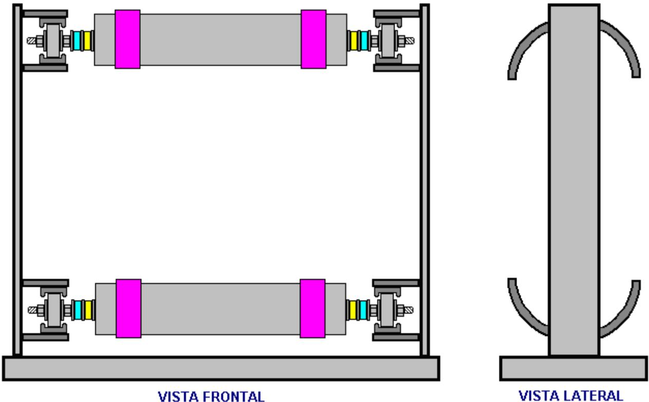
Este método mantiene un cauce del bajo-fricción los rodillo-rumbos para seguir. Esto controla la posición de los pesos muy con precisión y las paredes del extremo también mantienen los apoyos el axels que sincroniza las posiciones de los pesos y proporciona el engranaje entre el axels si eso se requiere. Para la claridad, sólo dos del se muestran muchos pesos y las proporciones globales torcieron para que el diagrama encajara en la página.
