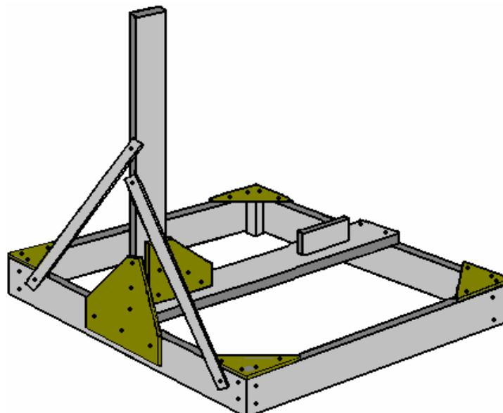
Una tira de madera espesor 18 mm se atornilla a la parte superior de las verticales. Esto posiciona deliberadamente la madera 18 mm de centro como el motor que gira la parte superior del eje del eje tiene que acoplarse a la mitad de esta madera más reciente y que pone el eje del motor muy cerca del punto central de la base:
