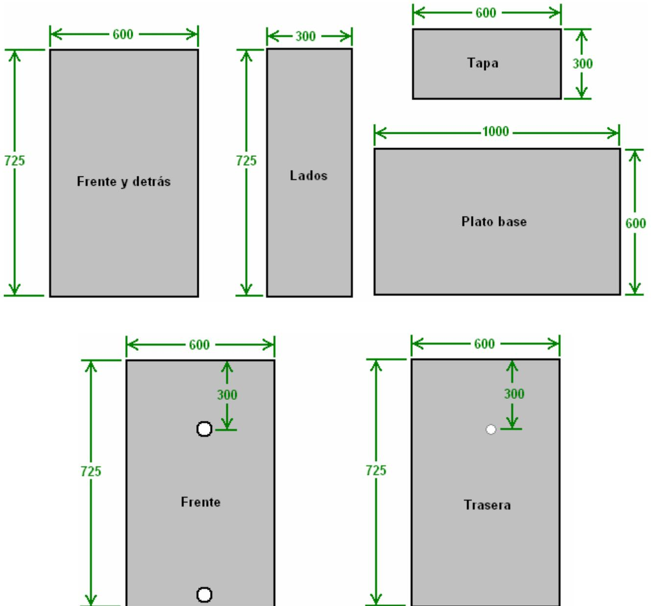
El siguiente paso es construir las placas deflectoras para atrapar los chorros de líquido que salen de las boquillas del tambor. Primero, se crea un agujero en el panel frontal y se adjunta el rodamiento. El cojinete será el mejor cojinete de 75 mm de diámetro que se ajustará a su tubo de admisión y se montará de manera segura en el panel frontal:
