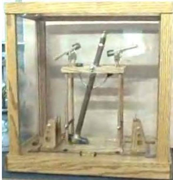
Qué indica el balance cubre una distancia bastante corta. Montado cerca de la cima del péndulo, hay dos brazos montados sobre un eje que se parecen los micrófonos realmente, debido a tener imanes grandes montados en sus más profundo extremos:
