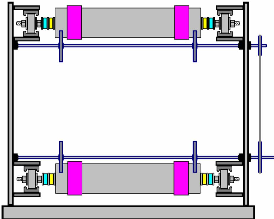
Aquí, los árboles del axel se engranan juntos fuera de la pared del extremo y o una cadena o un paseo del cinturón usaron. El más bajo árbol permite un despegue de poder. La proporción de los diámetros de las ruedas de la polea o dictados de ruedas de diente las proporciones relativas de rotación de los dos árboles.
