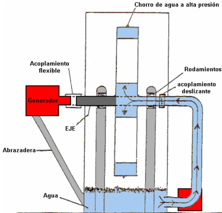
La única parte difícil de este diseño parece ser el acoplamiento deslizable en una tubería de agua estacionaria se une a una tubería de agua rotatorio. Si bien estamos familiarizados con la rotación de los aspersores de césped que giran utilizando exactamente los mismos principios que este motor Donnie Watts, a saber, la acción chorro por impulsos, como se muestra aquí:
