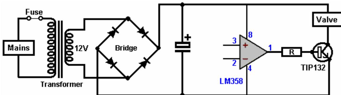
El TIP132 puede manejar 100 voltios, 8 amperios y tiene una ganancia de 1000, por lo que si está pasando 330 miliamperios a través del devanado de la válvula, necesitará una corriente base de 0,3 miliamperios. Esa corriente fluye a través de la resistencia "R" que tiene unos 10 voltios a través de ella. Resistencia = voltios / amperios o  $10 / 0.0003$  amperios, que es de 33,333 ohmios o 33K. Sin embargo, aumentaremos la corriente base en un factor de 3 y utilizaremos una resistencia de 10 K:
