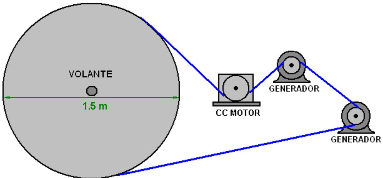
Hubo también un rodillo de tensado de correas que no se muestra en el diagrama por encima del cual se supone que el volante ha sido ranurado para tomar la correa de transmisión. Esquemáticamente, la disposición fue así:
