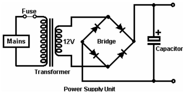
Al igual que con todos los circuitos, y especialmente con los circuitos principales, instalamos un fusible o un interruptor automático como primer componente, y aislamos todos los componentes metálicos para asegurarnos de que no los toquemos accidentalmente y recibamos una descarga desagradable.
