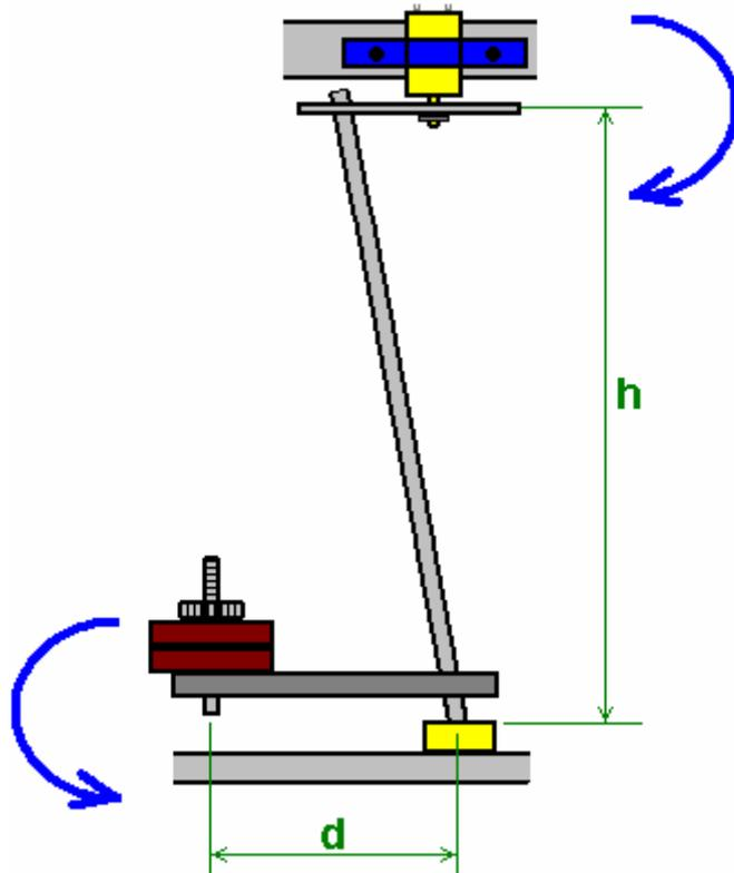
Esta es la posición cuando está en reposo. La fuerza del motor en la parte superior del eje del eje está  $W \times d / h$  donde  $W$  es el peso al final del brazo  $d$ . La situación cambia inmediatamente se gira la parte superior del eje del árbol y el peso  $W$  comienza a girar bajo la influencia de la gravedad.
