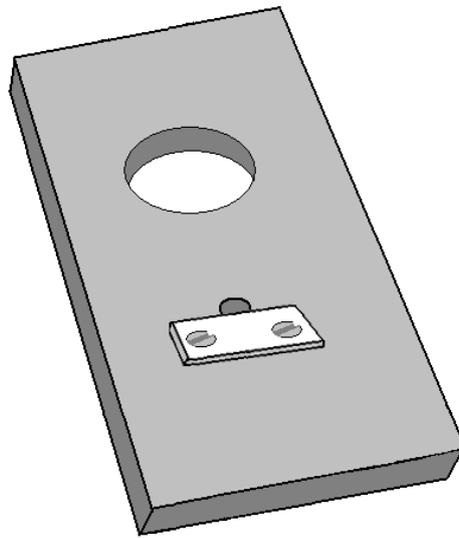
Tal vez corte un orificio de tamaño adecuado a través de una tira de material y usando una tira de metal prensado en la cara plana del eje motor impulsor (además del agujero siendo un empujón fuerte ajuste) sería adecuadas para ello. Un collar atornillado o capa de resina epoxi sostiene que firmemente la placa del motor como la placa se coloca debajo del motor y por gravedad tiende a sacar la placa del motor en todo momento.
