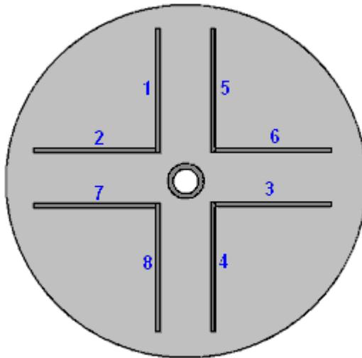
Utilice las abrazaderas magnéticas para mantener vertical cada placa al posicionarla y soldarla por puntos:
