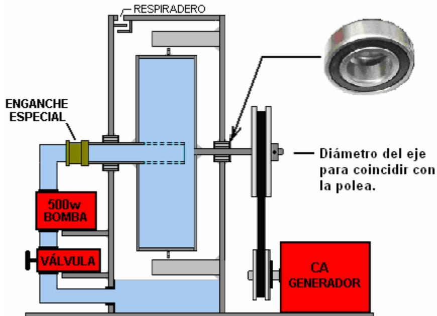
Si bien el eje del eje puede estar formado por dos piezas soldadas entre sí y soldadas al tambor, sugiero que es más práctico soldar el tubo de tres pulgadas de diámetro al tambor y luego elegir un diámetro de barra que coincida con el tamaño necesario para la rueda de la polea elegida, esa barra está soldada al otro lado del tambor como se muestra arriba. La parte del eje a la derecha es sólida y proporciona el accionamiento al generador:
