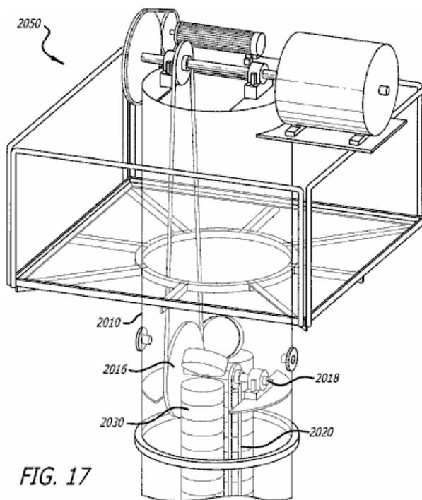
**Fig.17** muestra la disposición en la parte superior del tanque agua **2010**. Cubos **2030** aumento debido a estar llena de aire, voltear como pasan alrededor de la polea superior **2018**, liberando el aire en su interior y bajar nuevamente hacia la polea inferior. El eje superior **2018** tiene una velocidad de rotación **estimada** de 120 rpm.
