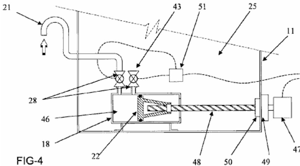
Una construcción alternativa de la reserva de aire primero **18** se muestra en **Fig.4**. En esta realización, el depósito **18** está alojado dentro de un recipiente **11** que contiene un fluido **25**. El aire entra en el depósito **18** a través de la entrada de aire **21** y se mantuvieron en una cámara **46**. El depósito tiene un pistón **22** y el movimiento del pistón **22** hacia la izquierda del depósito **18** fuerzas aéreas en la cámara **46** a través de la salida de aire **43**.
