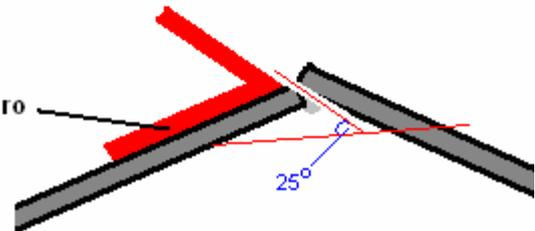
El único orificio de perforación en el centro de la pared de la circunferencia del tambor actúa como un chorro y al utilizar la plantilla para obtener el ángulo de la broca de la misma forma, produce chorros de agua con el ángulo correcto.
