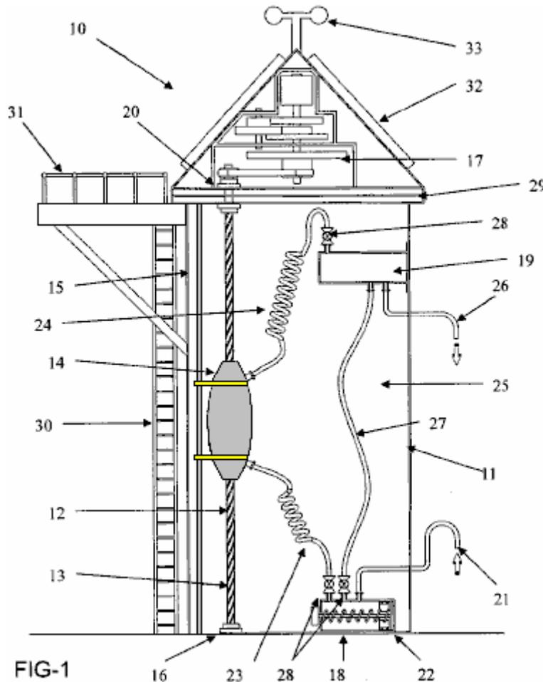
**Fig.1** es una visión transversal de una encarnación del sistema de generación de energía de la invención presente. Aquí, la generación de energía sistema **10** está compuesto por un recipiente **11** en forma de un tanque de agua y un eje **12** que puede girar sobre es eje longitudinal. El eje **12** está provisto de un tornillo helicoidal surco **13** y está conectado en su extremo inferior a un rodamiento **16** que permite girar libremente sobre su eje longitudinal.
