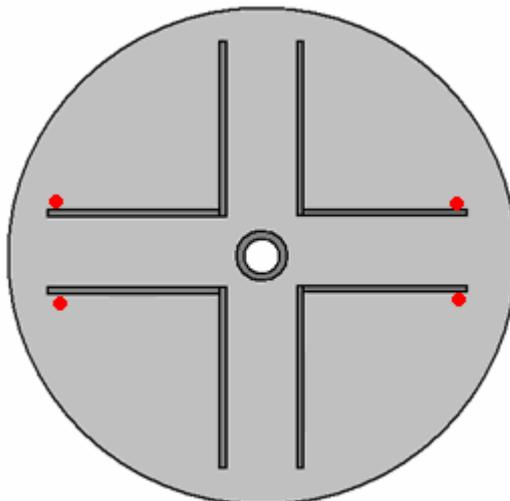
Luego, puede dar la vuelta al tambor para que todas las soldaduras siguientes estén hacia abajo y no sea probable que el metal caliente llegue a sus manos. Hay espacio para soldar dentro del tambor, ya que las piezas que forman las paredes del canal tienen una longitud de solo 150 mm y hay una separación de 144 mm entre los lados del tambor.
