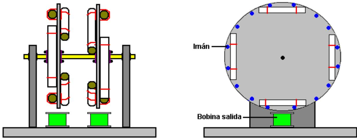
Si el rotor gira bien, entonces valdría la pena atar una serie de imanes a los discos, tener cuidado guardan cada disco perfectamente equilibrado. Uno o varios bobinas principales de aire pueden ser usados entonces para determinar de ser corriente puede ser dibujado del dispositivo sin parar la rotación. Los bobinas no deberían tener un corazón magnético cuando esto causaría a un comandante se prolongan la rotación si corriente estaba siendo dibujado o no.
