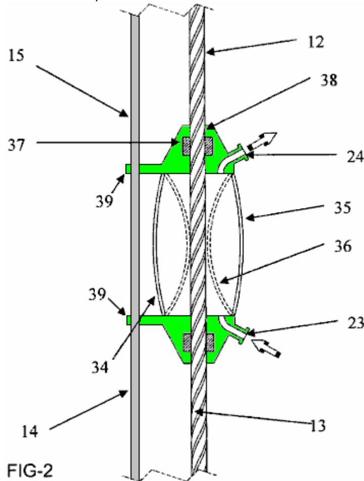
**Fig.2** muestra un arreglo para boya **14** compuesto por una cápsula inflable **34**. Esta figura ilustra la forma de las paredes de la cápsula inflable cuando **34** inflado **35** y cuándo desinflado **36**. El aire pasa a la cápsula **34** a través de la manguera **23** y sale de la cápsula a través de manguera **24**.
