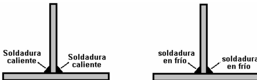
Luego, a medida que las soldaduras se enfrían, tiran en direcciones opuestas y, mientras produce tensiones en el metal, la pieza vertical se mantiene vertical. Deje que las soldaduras se enfríen en su propio buen momento, tomando quizás diez minutos para enfriarse adecuadamente. **No** aplique agua a las soldaduras para acelerar el enfriamiento, ya que esto altera realmente la estructura del acero y realmente no quiere hacerlo.
