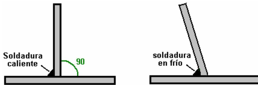
Por favor, no imagine que solo puede colocar la pieza vertical en su lugar, ya que eso no va a suceder porque la unión es instantáneamente muy, muy fuerte. En su lugar, utiliza dos soldaduras rápidas de igual tamaño, con la segunda 180 grados opuesta a la primera:
