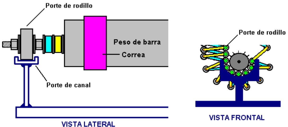
Un cauce guiando puede usarse, como mostrado aquí, y pueden atarse cojinetes de bolas normales o rodillo-rumbos a los extremos de los pesos usando la vara enhebrada (o una saeta con la cabeza dentro del peso) y cerrando con llave las nueces.
