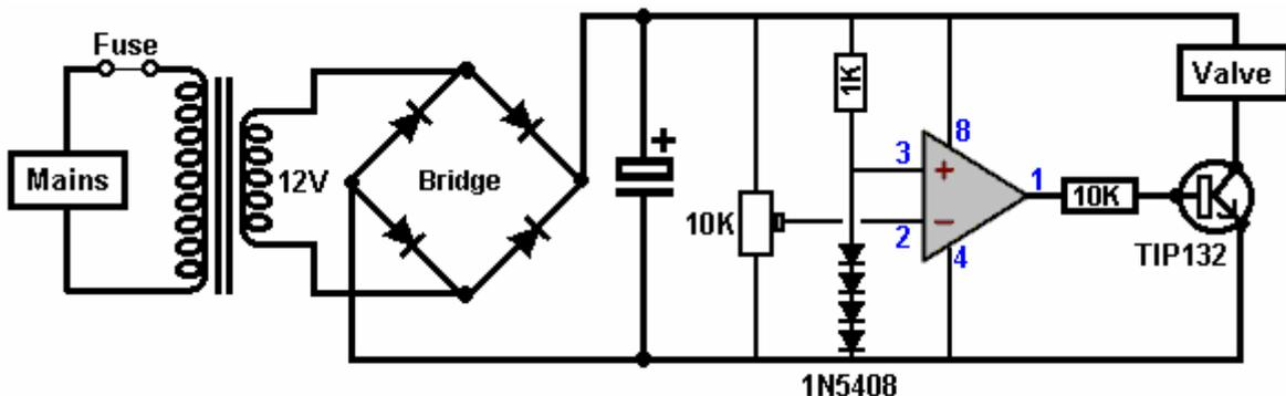
Esta disposición proporciona aproximadamente 10 miliamperios que fluyen a través de la cadena de diodos y se generan unos 2,75 voltios a través de los diodos. Esa tensión no se altera apreciablemente si aumenta la tensión de alimentación.
