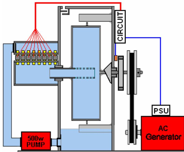
La forma más directa de determinar la velocidad del eje de salida es conectar un disco al eje y usar un sensor para detectar con qué frecuencia pasa un imán en el disco. Un circuito del contador de revoluciones monitorea la velocidad del eje y apaga las válvulas progresivamente si el eje comienza a girar demasiado rápido.
