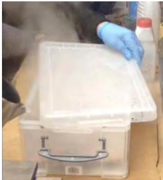
Se uma placa de cobre está sendo tratada, então ambos os lados precisam estar em contato com a solução de soda cáustica, então para conseguir isso uma mesa baixa de malha de arame é usada para manter a parte de baixo da placa de cobre livre da base da caixa de tratamento. . Quando o processamento estiver concluído, a placa de cobre ficará preta em todas as faces.
