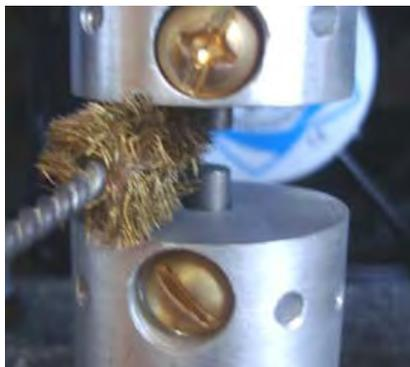
em torno das hastes de tungstênio e do alumínio que segura as hastes. Quando isso for concluído, eu uso um pequeno arquivo e gentilmente arquivar o final das duas varas até que elas brilhem novamente. Então eu as explodo com um limpador de latas de ar para limpeza do teclado, a menos que o ar comprimido esteja disponível e, finalmente, ajuste as folgas para o tamanho desejado.
