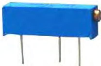
Este estilo de resistor variável pré-ajustado é barato e tem vinte voltas do parafuso final para variar a resistência entre o pino central e o pino final de zero a 200 ohms, facilitando a seleção da configuração que fornece uma escala completa. 15 volts "indica a leitura quando a tensão de entrada é de 0,09 volts. Na verdade, a parte mais difícil é obter a tensão CC de 0,09 volt para a entrada para obter a configuração correta do resistor predefinido. A configuração é assim:
