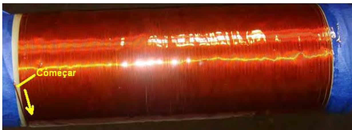
No entanto, a bobina de transmissão de Tesla e a bobina de recepção de Tesla precisam ressoar em diferentes frequências, então enrole a bobina de recepção com 350 voltas de fio para obter uma frequência de ressonância menor. Queremos que a diferença de frequência entre as duas bobinas seja de 100 kHz. Conseguir isso acontecer não é tão fácil assim.
