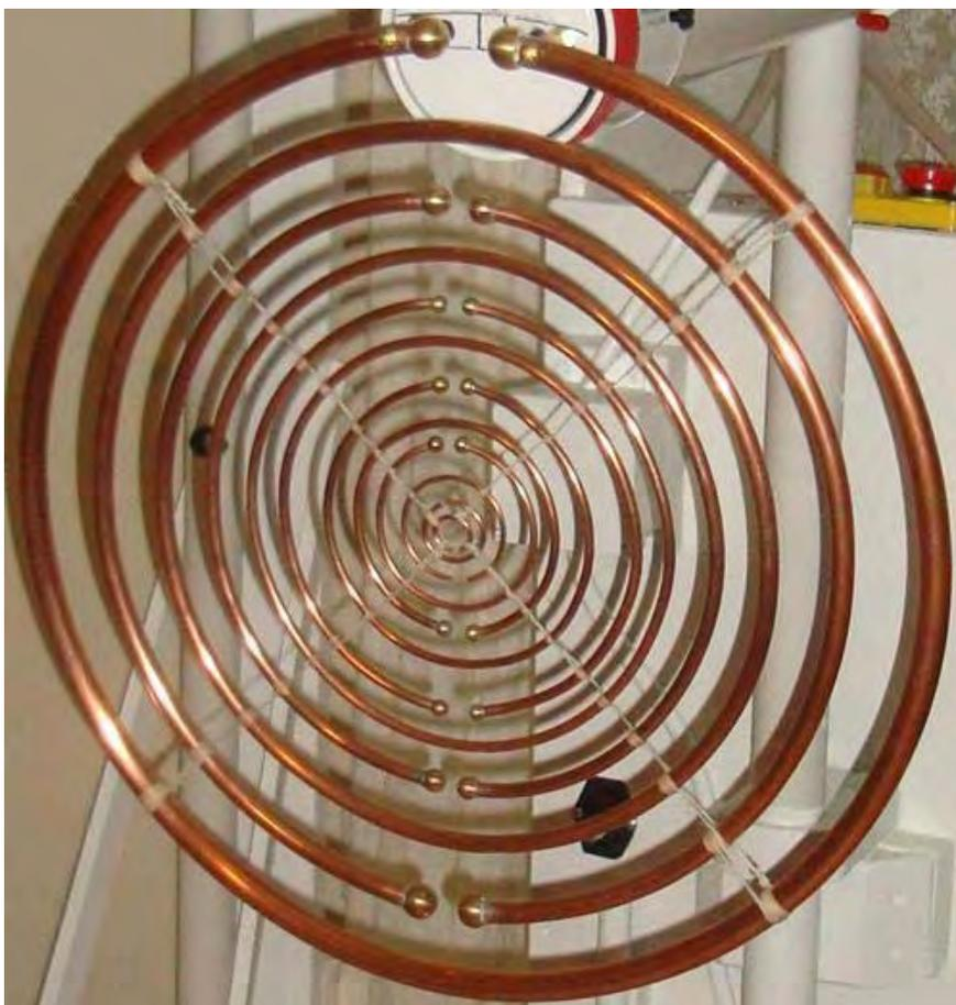
Você notará que existem muitos diâmetros diferentes de tubos de cobre usados nesta antena e que, combinados com o diâmetro do círculo no qual cada tubo é dobrado, faz com que cada seção do tubo entre em ressonância com uma frequência diferente, e isso é o funcionamento coração do design, mas mais disso mais tarde.
