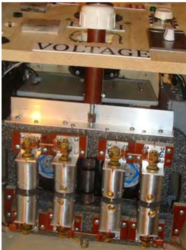
Um detalhe a ser mencionado é a ponta de cada lacuna de centelha. Como essa parte esquenta, usar o tungstênio é sensato e, portanto, o construtor comprou em oito peças, cada uma com uma polegada (25 mm) de comprimento e um quarto de polegada (6 mm) de diâmetro. Estes foram comprados no eBay:
