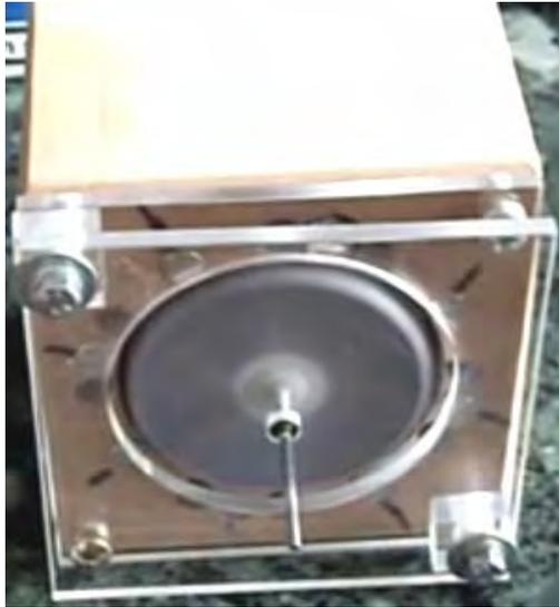
Como no hay ningún comentario en el video, es un poco difícil recoger todos los detalles, pero parece que la colocación de imanes del estator permite que el motor venza el punto neutro típico de un motor con una configuración de imanes en V. El vídeo muestra varias configuraciones, incluso la asimétrica mostrada aquí donde se usan cuatro o cinco imanes consecutivos y las ranuras restantes se dejan vacías.
