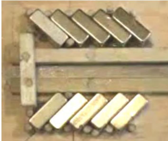
Los imanes se sostienen en pie en esta foto, por espigas de madera clavadas en la tabla base. Éstos utilizaron para evitar cualquier material de sujeción del imán que podría alterar el campo magnético.
