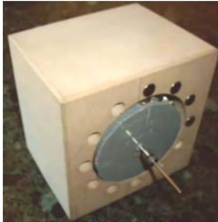
La separación entre el borde del alojamiento y el tambor de imanes del rotor, es bastante grande. El rodamiento que sostiene la parte trasera del eje, esta embutido en la parte trasera del alojamiento.
