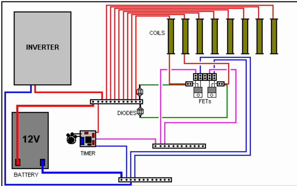
La placa del temporizador se puede unir a la placa base con un tornillo o un perno. El tablero es muy ligero y robusto y un solo tornillo es suficiente para mantenerlo en su lugar. La resistencia variable y las tres tiras de conexión se pueden pegar a la placa. Algunos constructores odian la idea, pero mi método preferido es usar Impact Evostick como pegamento, ya que es muy efectivo y después de un día se vuelve realmente muy fuerte.
