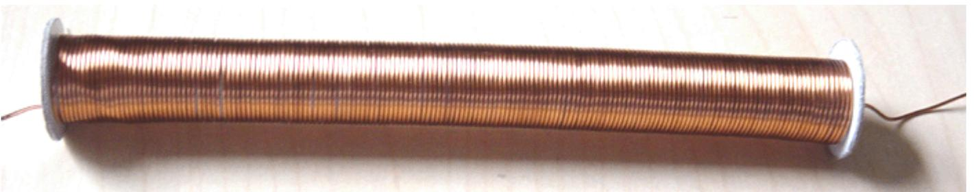
Este generador se puede construir en miles de variaciones, la principal diferencia son las bobinas que se utilizan: el material del núcleo, la longitud del núcleo, el diámetro del cable y la cantidad de capas enrolladas. Por supuesto, puede comenzar con una bobina y ver cómo funciona su circuito, y más adelante, agregar una o más bobinas para aumentar el rendimiento.
