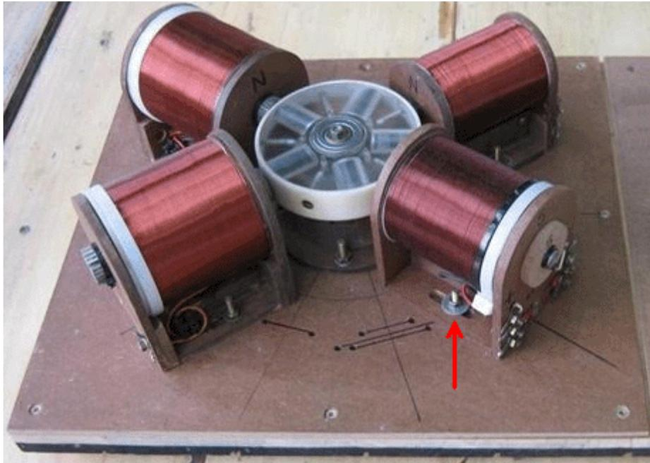
Nótese la forma en que los soportes de bobinas permiten que la distancia entre las bobinas y el rotor a ser cambiado. La brecha de trabajo entre el rotor y las bobinas se puede ajustar de manera que el rendimiento se puede maximizar mediante la búsqueda de la brecha más eficaz.
