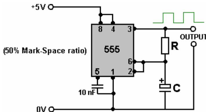
El condensador utilizado debe ser de alta calidad con una fuga muy baja para obtener esta forma de onda que está encendida exactamente el mismo tiempo que está apagada. Esto es importante si queremos que las dos baterías reciban la misma cantidad de tiempo alimentando la carga que el tiempo que reciben al recargarse.
