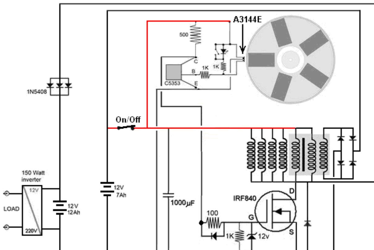
Aquí, la batería que alimenta el inversor que suministra la carga aumenta su capacidad y mientras el desarrollador usó dos de sus baterías de 7 Amp-Hour, puede usar una batería estándar de 12 voltios y 12 amperios hora para un scooter de movilidad. Todas menos una de las bobinas se utilizan para suministrar corriente a la batería de salida y la única bobina restante, que es parte de la bobina principal de tres hilos, se utiliza para suministrar la batería de accionamiento directamente.
