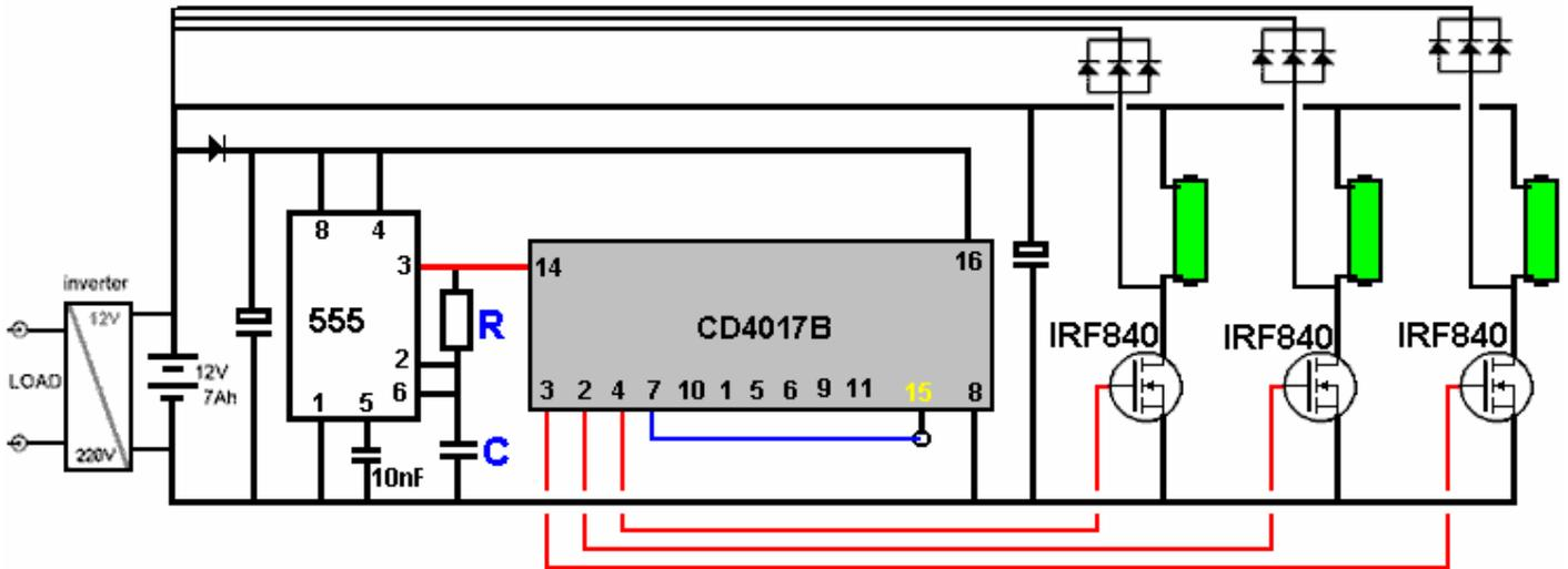
Para una salida dividida por 4, el pin 10 se conectaría al pin 15 de reinicio y la cuarta salida sería del pin 7 y la frecuencia del pulso del reloj 555 aumentaría a cuatro veces la tasa original bajando el valor de "C" o aumentando el valor de "R".
