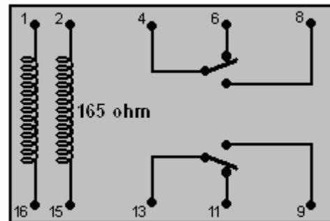
Esta es la versión electrónica de un interruptor mecánico de dos polos. Un breve pulso de corriente entre los pines 1 y 16 bloquea el interruptor en una posición y más tarde, un pulso de corriente entre los pines 2 y 15 lo bloquea en la otra posición. La fuga de corriente en el circuito sería casi cero.
