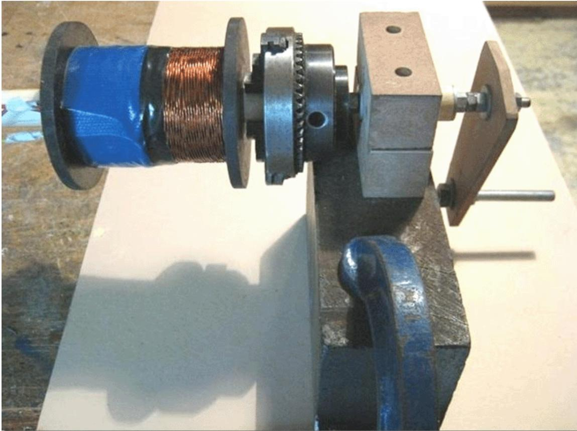
Los tres hilos de alambre que forman bobinas "1", "2" y "3" son alambre de 0,7 mm de diámetro y están trenzados entre sí para convertirse en un cable "Litz" antes de ser arrollado en la bobina "B". Esto produce un hilo de alambre de material compuesto mucho más gruesa, que es fácil de enrollar con precisión en el carrete. La bobinadora se muestra arriba utiliza un mandril para sujetar el núcleo de la bobina para enrollar, pero cualquier bobinadora sencilla funcionará bien.
