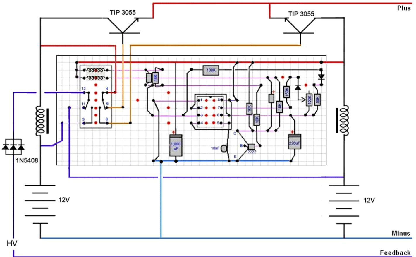
Los transistores TIP3055 están ahí solo para aumentar la capacidad de carga actual del pequeño relé de enganche. Decidamos construir una versión muy simple del circuito pero permitiendo una expansión posterior para una mayor potencia de salida. Probemos esta disposición de circuito:
