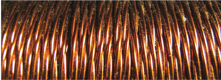
Esta bobina completado ahora contiene tres bobinas separadas en proximidad muy cercana entre sí y que arreglo es excelente cuando una bobina se enciende, para la inducción de la energía en las otras dos bobinas. Este arrollamiento ahora contiene bobinas de 1,2 y 3 del diagrama del circuito. No hay necesidad de preocuparse por el marcado de los extremos de cada hilo de alambre como un simple óhmetro le dirá cual dos extremos han devanado entre ellos.
