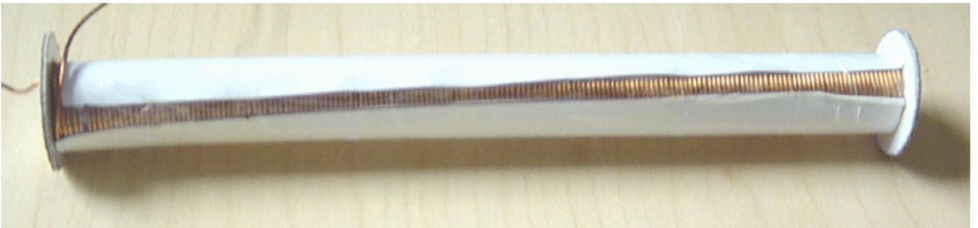
Ese proceso se repite hasta que se hayan enrollado todas las capas deseadas. Finalmente, el cable se corta con unas pocas pulgadas para conectar la bobina en el circuito, y el cable pasa a través de un segundo orificio en una de las bridas:
