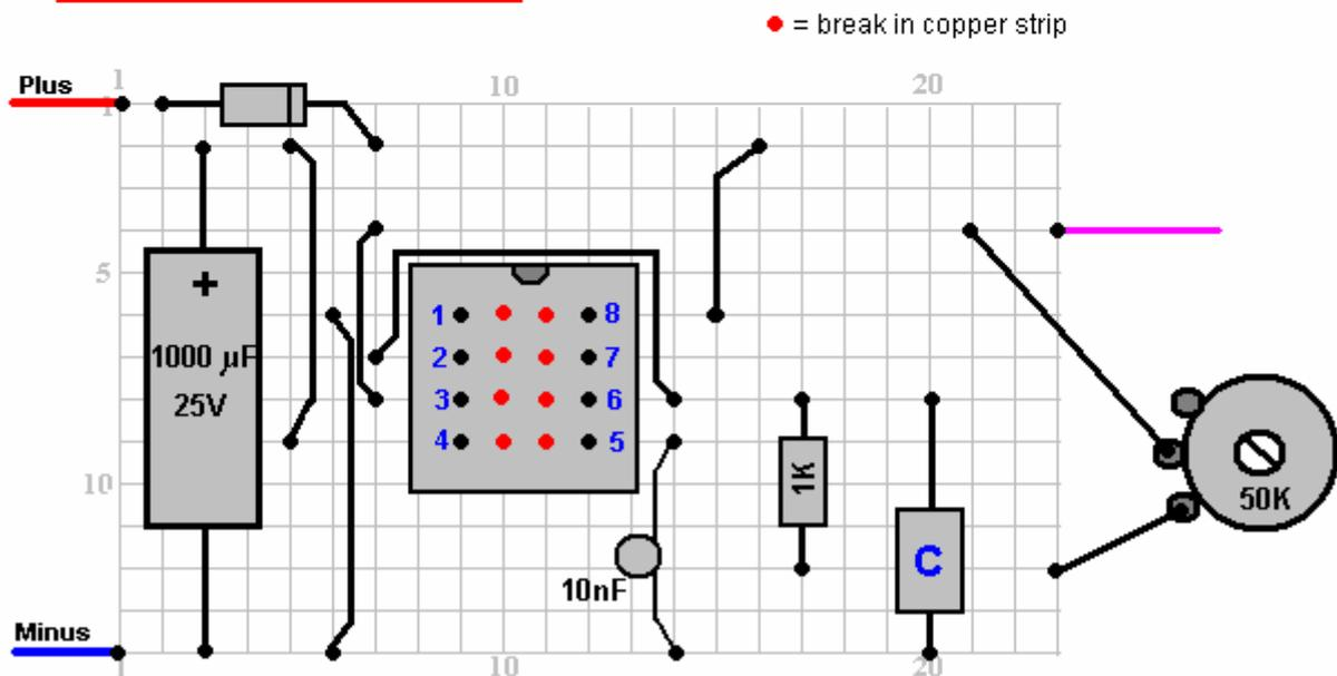
El condensador "C" será de aproximadamente 10 nF y la resistencia variable puede ser 47K o 50K lineal o se podría usar un valor más alto.
