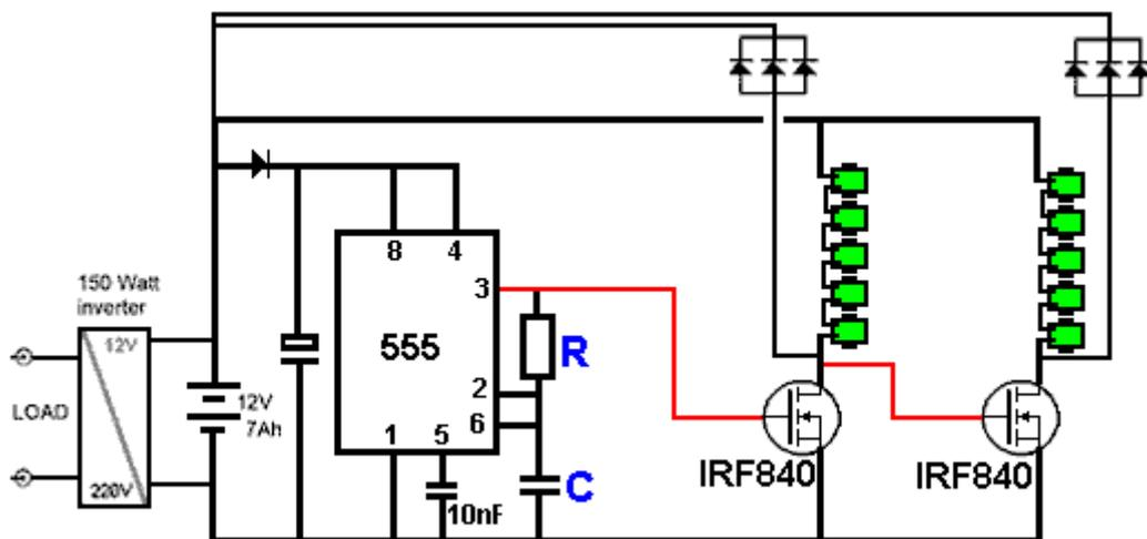
Luego, cuando el primer transistor se enciende, el segundo transistor se apaga y viceversa. Hacer eso devuelve el doble de pulsos por segundo a la batería de la unidad sin aumentar la velocidad de pulsación de ninguna de las cadenas de la bobina. Recuerde también, que los transistores son lo suficientemente potentes como para impulsar varias cadenas de bobinas simultáneamente, y se puede esperar que cada bobina extra aumente la potencia de salida excedente disponible.
