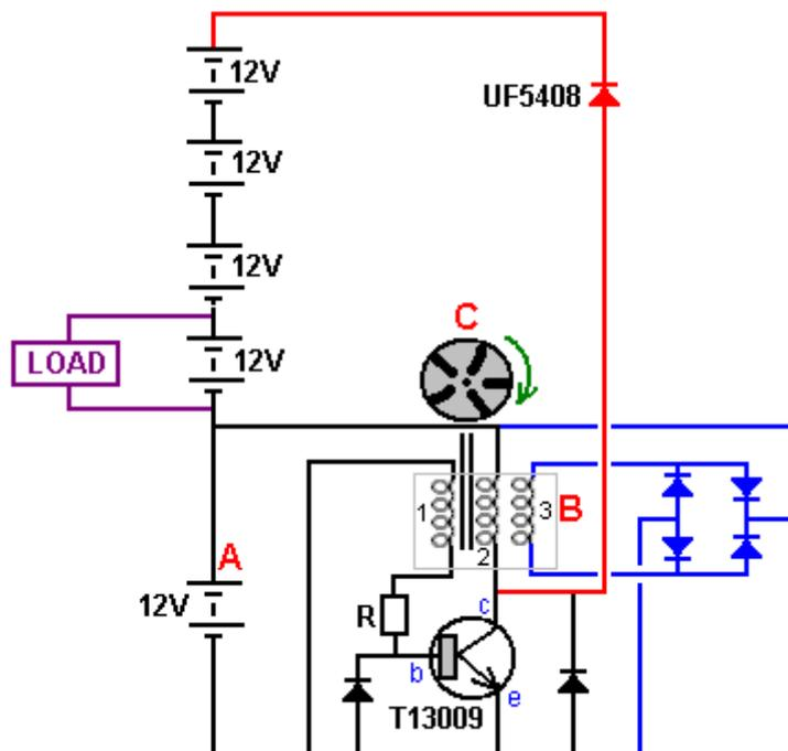
La batería marcada poder "A" del circuito. Un rotor "C", que contiene cinco imanes se mueve de modo que uno de los imanes pasa cerca de las bobinas. Las bobinas establecidos "B" tiene tres bobinas especialmente la herida y el imán se mueve más allá de esas tres bobinas genera una pequeña corriente en número bobina "1", que fluye entonces a través de la resistencia "R" y en la base del transistor, haciendo que se encienda. El poder
