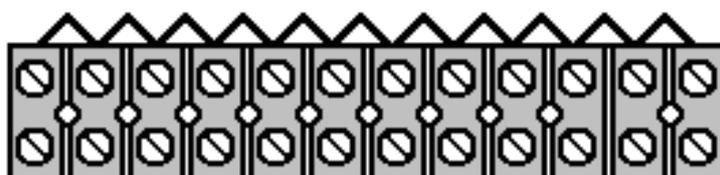
Tenemos un problema con la conexión de los transistores FET porque sus pines están tan juntos que no encajan convenientemente en un bloque conector de tornillo. Podemos evitar ese problema cortando un conector del bloque, doblando la clavija central del FET hacia arriba en una posición vertical y usando el único conector de corte para hacer la conexión al pin central del FET:
