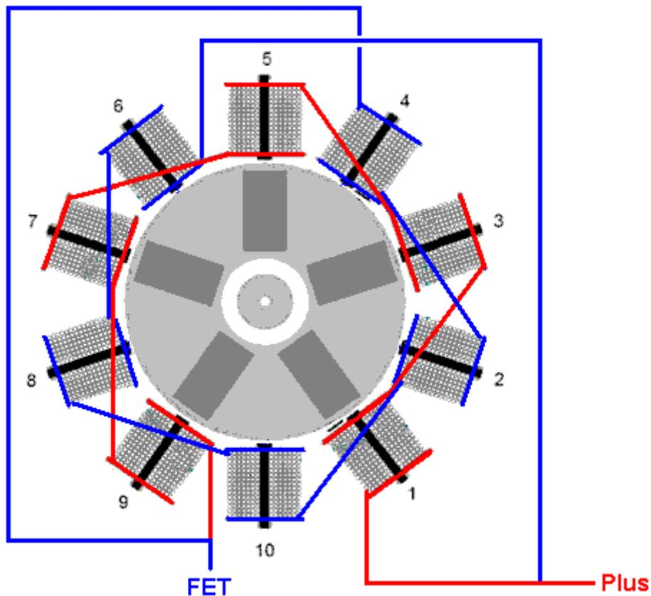
Las diez bobinas se pulsán en el mismo instante y ese instante está dispuesto a suceder cuando un imán de rotor se encuentra entre las dos bobinas opuestas. Una bobina aleja el imán y la otra bobina tira del mismo imán hacia sí misma. Esto es muy efectivo con el rotor girando tan rápido que el desarrollador lo describe como "aterrador" y tiene que sujetarlo al banco de trabajo debido a la potencia que se genera.
