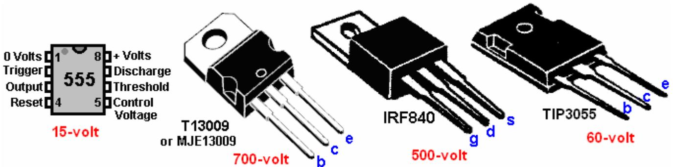
Si decide utilizar una entrada de 24 voltios, recuerde que tanto el chip 555 como el 4017 deben mantenerse a 12 voltios, ya que no pueden manejar 24 voltios. Además, necesita un inversor de 24 voltios si decide hacerlo.
