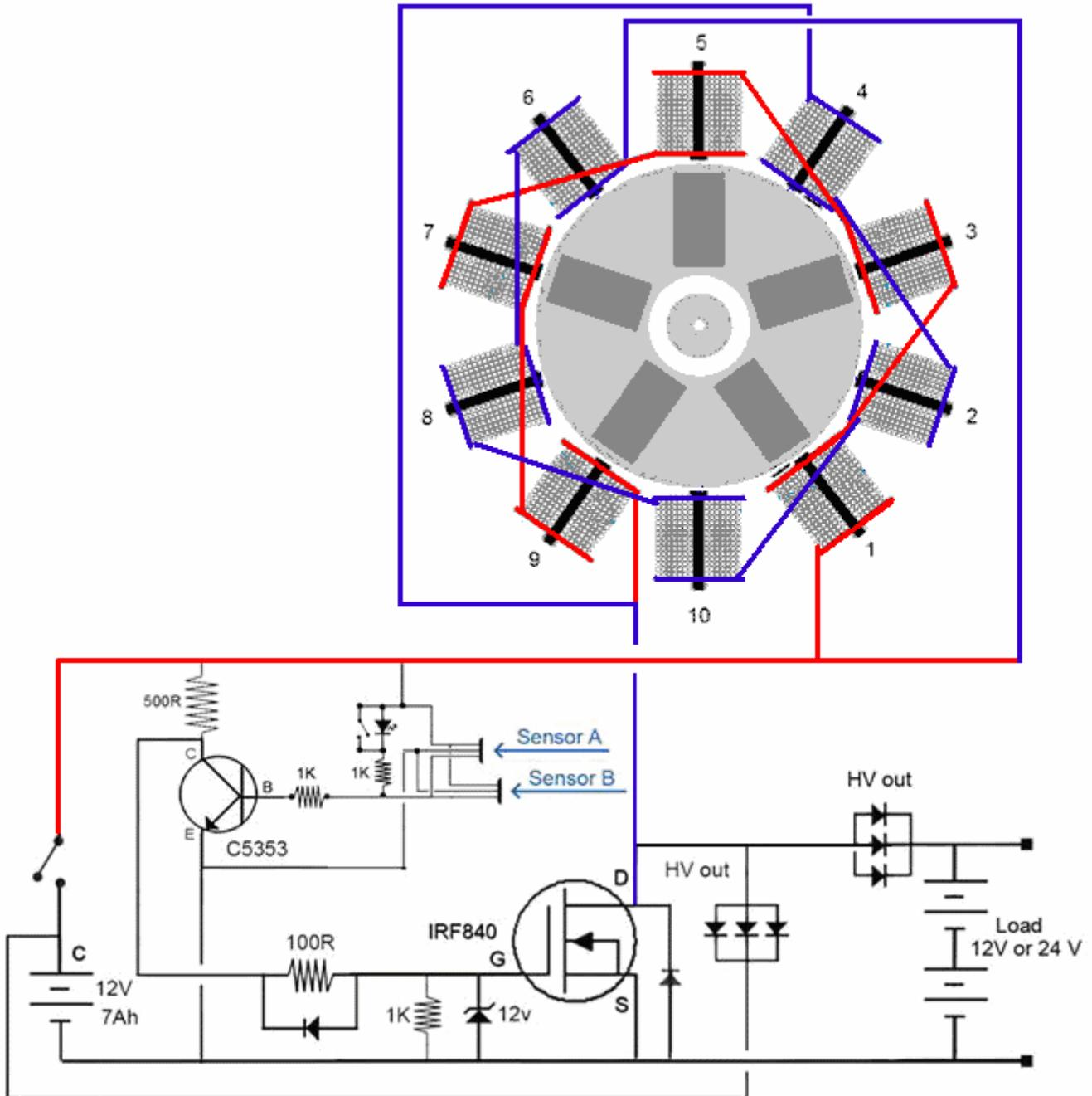
Si queremos reproducir este rendimiento sin el rotor y sus imanes, entonces necesitamos aplicar pulsos de 12 voltios a esas dos cadenas de bobinas 417 veces por segundo. Esto puede sonar difícil si no está familiarizado con la electrónica, pero en realidad es una tarea muy simple y 417 Hz es una operación muy lenta para un circuito electrónico, ya que podrían generar fácilmente 3.000.000 de pulsos por segundo.
