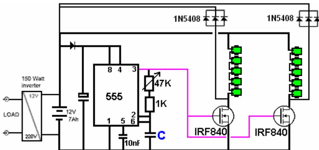
Esta disposición permite una alteración considerable de la frecuencia de funcionamiento simplemente girando una perilla. Los constructores experimentados tendrán sus propios métodos de construcción preferidos, pero podríamos elegir utilizar un diseño en un tablero abierto para que sea más fácil ver lo que está sucediendo y proporcionar un buen enfriamiento durante la etapa de desarrollo, tal vez algo como esto:
