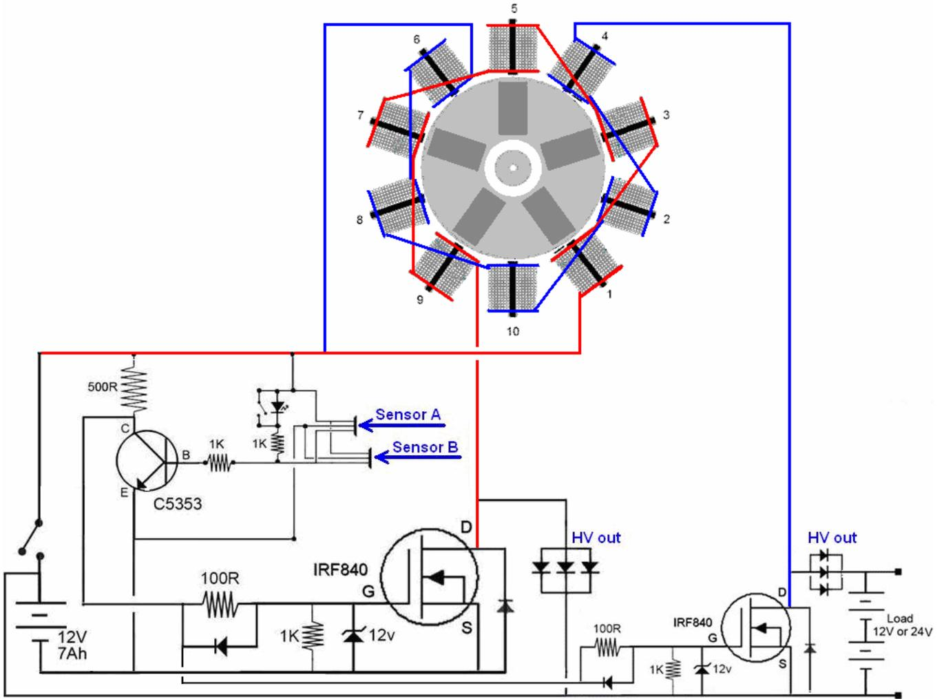
Tal como está, este circuito puede cargar baterías de 12V o 24V o alimentar un inversor de 12V conectado a través de una batería de 12V, o un inversor de 24V conectado a través de una batería de 24V. Una versión de este circuito con menos componentes que funciona muy bien es esta:
