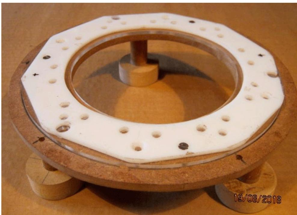
As pequenas bobinas são mantidas no lugar com abraçadeiras e são fáceis de remover. Cada bobina tem uma resistência de 0,8 ohms e os núcleos são parafusos de ferro galvanizado padrão de 6 mm de diâmetro que não retêm o magnetismo, ou seja, não se tornam ímãs permanentes independentemente de serem repetidamente acionados repetidamente com um ímã permanente forte. O conjunto de dez bobinas montadas ao redor do rotor se parece com isso:
