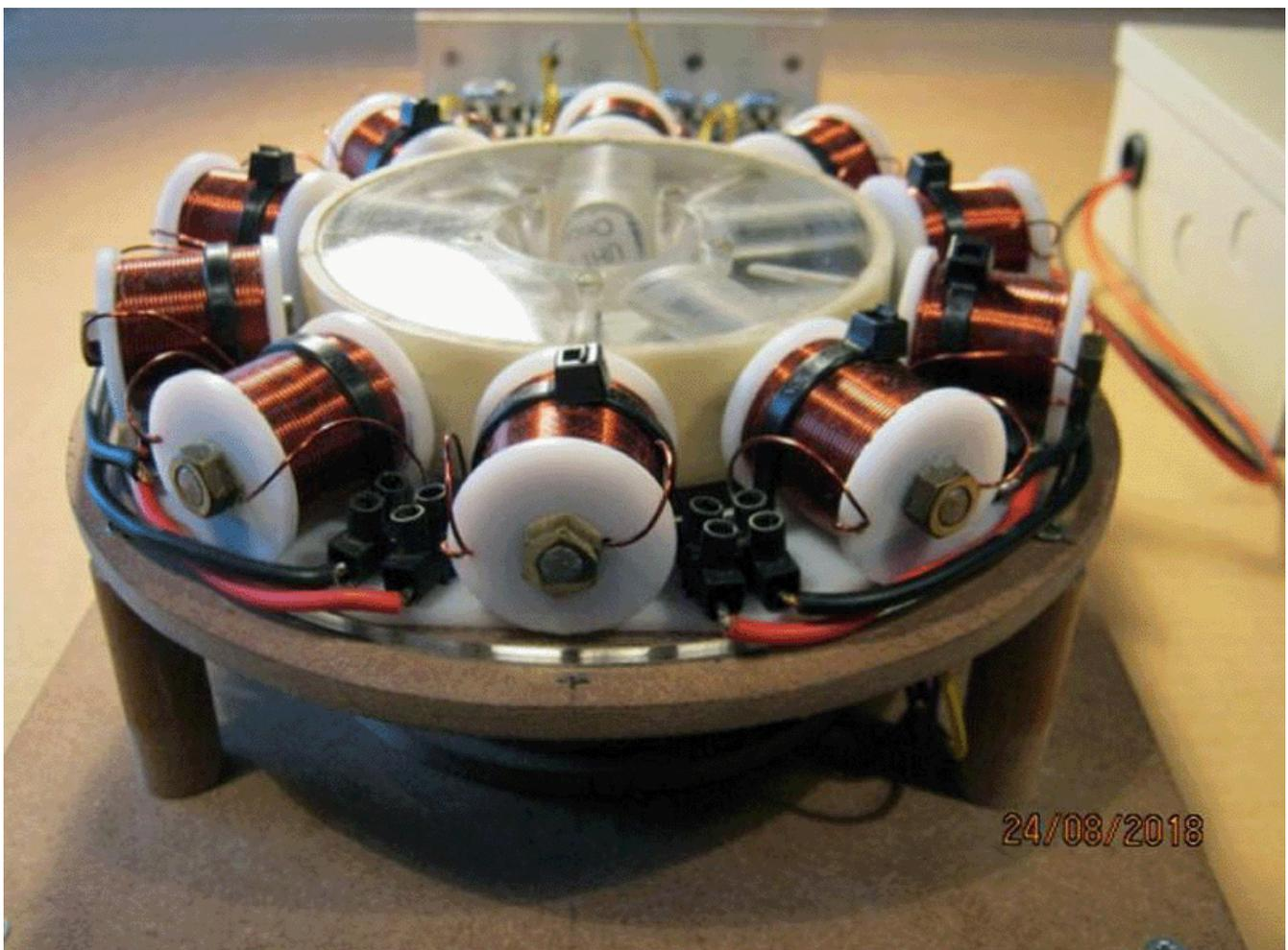
Denken Sie daran, dass die Spulen auf einem eigenen Stützring montiert sind und somit als eine Einheit gehandhabt werden können. Das ist sehr praktisch.
