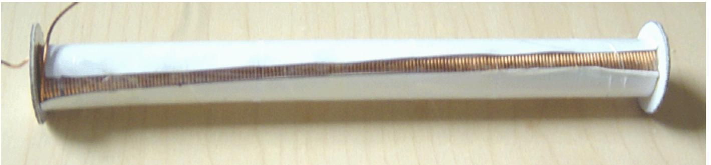
Dieser Vorgang wird wiederholt, bis alle gewünschten Schichten aufgewickelt sind. Schließlich wird der Draht mit ein paar Zoll Länge geschnitten, um die Spule im Stromkreis zu verbinden, und der Draht wird durch ein zweites Loch in einem der Flansche geführt:
