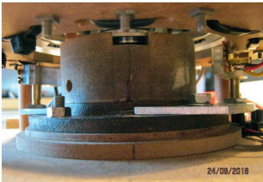
Es ist wichtig zu verstehen, dass, während der Rotor mit 110 mm Durchmesser fünf Magnete hat, die in gleichmäßigen Abständen um seinen Umfang herum angeordnet sind, es nun zehn Spulen auf dem umgebenden Stator gibt und es jetzt zehn Impulse pro Umdrehung gibt. Diese Impulse sind stark und wenn der Strom abgeschaltet wird, erzeugt jede Kette von fünf Spulen 600 Volt Spitzen (obwohl diese manchmal 900 Volt erreichen kann).
