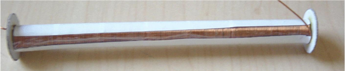
Sie haben jetzt eine perfekt gewickelte erste Schicht. Bevor Sie die zweite Schicht beginnen, schneiden Sie den nächsten 40 mm breiten Papierstreifen aus. Kleben Sie einen Streifen Selotape über die gesamte Länge des Papiers, wobei die Hälfte der Breite des Selotapes das Papier überlappt und legen Sie es beiseite. Wickeln Sie die nächste Schicht auf die gleiche Weise, indem Sie das Papier mit zwei Drahtschichten um den Kern kleben und befestigen.
