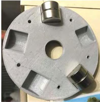
Dieser 3D-gedruckte Rotor besteht aus zwei Hälften, die dann miteinander verschraubt werden.
