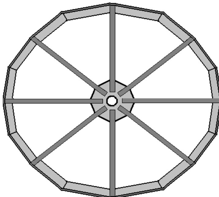
Pero en este caso, el peso total del volante se incrementa atornillando bloques de hormigón al interior de la llanta del volante, haciendo que un volante de 2,0 metros de diámetro pesa 800 libras y se adapta a un generador de 10 KVA (8 kilovatios). Un volante de 2,5 metros de diámetro pesa 1200 libras y se adapta a un generador de 25 KVA (20 kilovatios). El hormigón se utiliza ya que es a la vez pesado y barato y se puede unir a la llanta con pernos largos:
