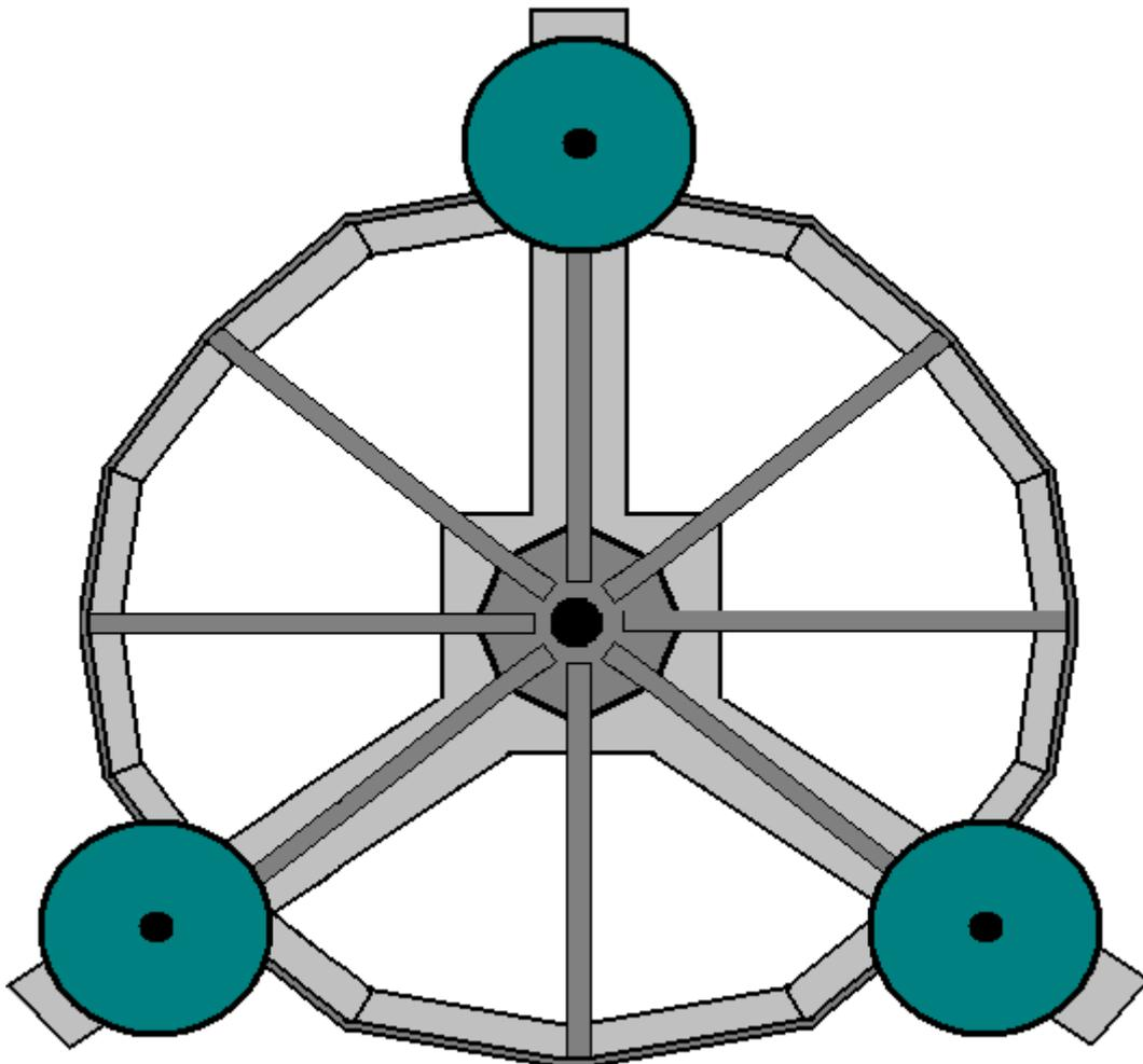
El eje central está atornillado al centro de la almohadilla de soporte de hormigón y tiene una polea de 16 pulgadas atornillada a ella:
