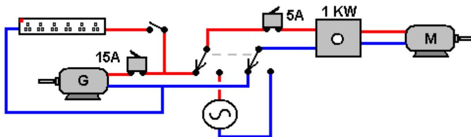
En la posición mostrada, el generador es la alimentación de corriente al motor de accionamiento "M". El interruptor de circuito de 15 amperios protege el generador "G" de un cortocircuito en cualquier otro lugar en el circuito. El disyuntor 5 amperios protege el interruptor de 1 kilovatio-atenuador y el motor "M". Con el interruptor en la otra posición, la red (o la salida de un inversor alimentado de la batería) se alimenta a través de al motor cuando está en marcha el sistema de.
