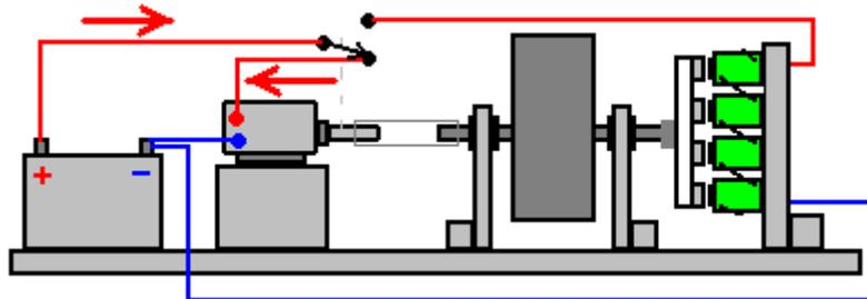
El motor de corriente continua se suministra energía en tres pulsos cortos por vuelta del eje del motor, la conmutación se realiza por los contactos sobre el eje del motor. La sincronización de los impulsos es la siguiente:
