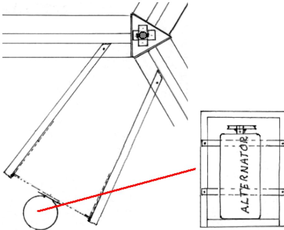
Y el bastidor de acero está montado verticalmente, apoyado en los ángulos fijados a las secciones de la caja de acero en la base concreta. Cuando se unen firmemente en posición, los hierros angulares verticales se erigen de los dos miembros de base para permitir el montaje de dos pivotes adicionales para las tres correas de transmisión que proporcionan el engranaje escalonado para accionar el alternador a poco más de 3000 rpm:
