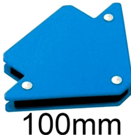
Questi allegare fortemente sia il tubo e il mozzo piatto e con uno ogni 90 gradi attorno all'asse, è tenuto molto saldamente in posizione, lasciando un sacco di spazio per la fase iniziale di saldature. A inizio 2016, un set di quattro di questi ad angolo retto magneti costa £10 in UK.
