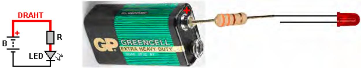
Und schließlich wird die andere Seite der LED mit dem Minuspol der Batterie verbunden:
