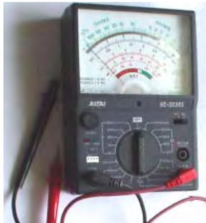
Die wirklich hervorragende nicht-Batterie (Ex-Profi) Avo Meter Multimeter noch über eBay zu erschwinglichen Preisen zur Verfügung. Diese haben 30.000 Ohm pro Volt Leistung und sind robust und präzise, mit sehr hohen Standards gebaut worden.
