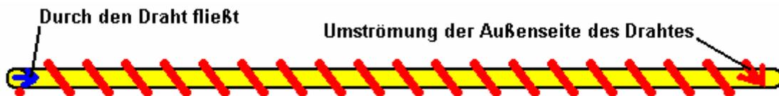
Die obige Skizze zeigt nicht die Proportionen korrekt, da der Stromfluss spiralförmig entlang der Außenseite der Leitung sollte Hunderttausende mal länger sein als dargestellt, welches nicht in einem Diagramm praktisch.
