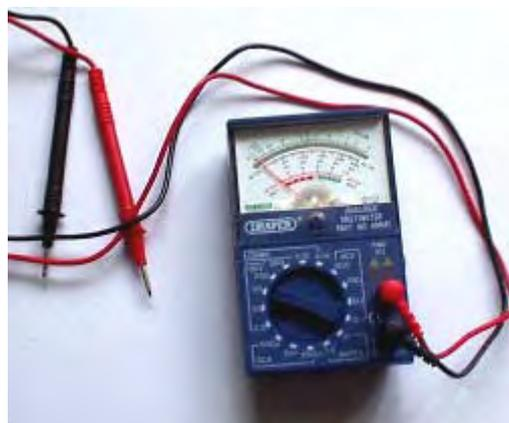
Das Messgerät oben gezeigt wird auf 2.000 Ohm pro Volt bewertet, so den Anschluss an einen Stromkreis zu machen eine Messung auf der 10V ist das gleiche wie das Anschließen eines 20K Widerstand an der Schaltung.
