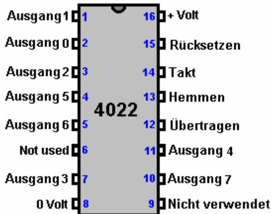
Wenn Pin 14, mit der Ausgabe von einige Vielzahl der astabile Multivibrator, am ersten Puls bereitgestellt wird, setzt dieser Chip die "0", der Ausgang an Pin 2 auf High, während die anderen Ausgaben niedrig sind. Am nächsten Puls die "0" Ausgabe niedrig und die "1"-Ausgang an Pin 1 geht hoch. Am nächsten Puls Ausgang "1" niedrig und die "2" Ausgabe auf Pin 3, geht hoch. Und so weiter, bis Ausgabe "7" auf Pin 10 auf die achte Puls niedrig geht und Ausgang "0" wieder hoch geht.
