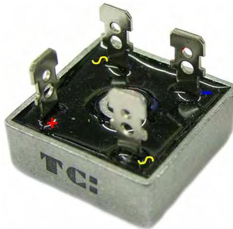
Das Wechselsignal zwischen zwei gegenüberliegenden Ecken verbunden sind und die pulsierende Gleichspannung wird von den beiden anderen Anschlüssen entnommen. Die Symbole oben gezeigt werden normalerweise auf der ebenen Fläche, die nicht in diesem Bild zu sehen ist markiert. Das Paket hat ein Loch in der Mitte, so dass das Metall bei einem Kühlkörper geschraubt werden kann, um zu halten das Gerät recht kühl bei der Durchführung großer Ströme. Die Verbindungen in der Verpackung sind wie folgt:
