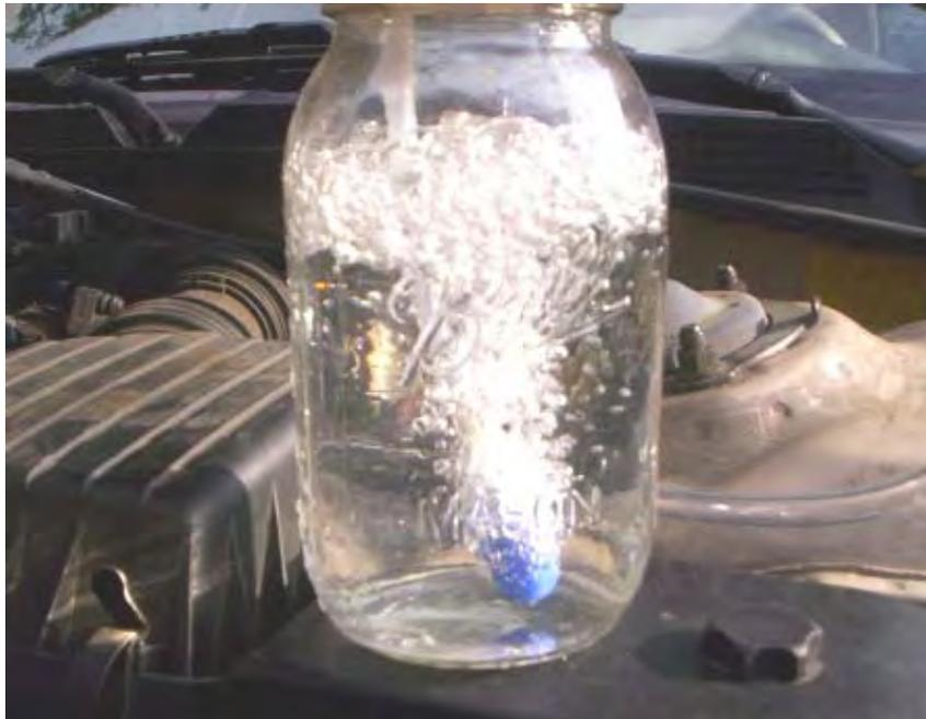
A unidade é conectada à entrada de ar do veículo, entre o filtro de ar e o motor. Um tubo de plástico de pequeno diâmetro é conduzido a partir daí para um recipiente de vidro ou plástico contendo água. Na foto acima, Roger está usando um frasco de vidro Mason com uma tampa metálica que tem um selo. Às vezes chamado de frasco de conservação, esses frascos são muito convenientes.
