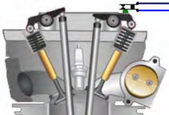
Uma alternativa é unir um ímã permanente forte ao balancim, usando resina epóxi, e então posicionar um sensor de "efeito Hall" de estado sólido para que ele dispare o atraso antes que a faísca seja gerada.
