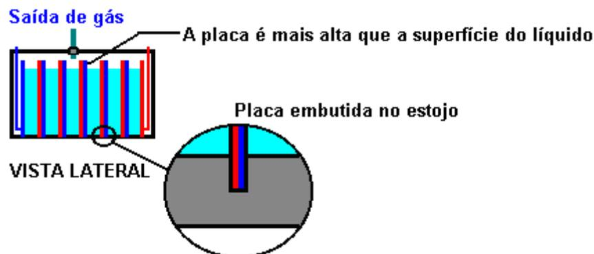
Um eletrolisador com cem células, construído neste estilo, terá 101 placas de metal e 100 corpos separados de eletrólito. Apesar desses grandes números, o tamanho da unidade total não precisa ser excessivo. O
