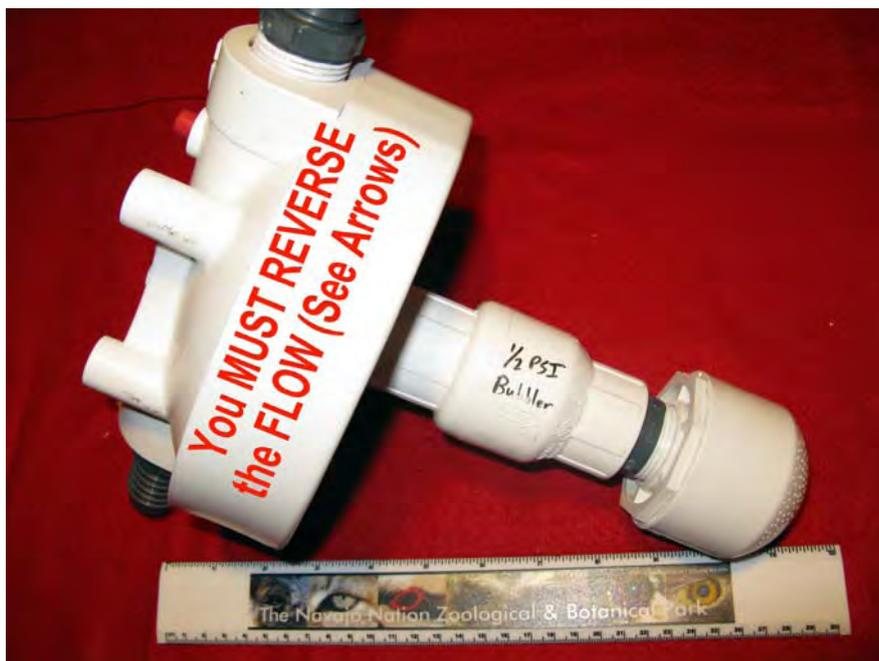
Além disso, a pressão na qual ele opera precisa ser reduzida da pressão normal da água da casa para 0,5 psi. pressão de gás necessária para uso como um bubbler. Isto é conseguido através da substituição da válvula de esfera no interior da unidade por uma versão muito mais fraca disponível na empresa KBI, o código de referência KC1000 e custando cerca de US \$10. Se você obtiver um, especifique uma versão de pressão de 0,5 psi, pois eles têm mais de um tipo.
