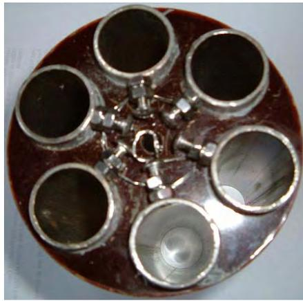
As conexões elétricas aos tubos são feitas através de fios de aço inoxidável que passam entre os parafusos de aço inoxidável batidos nos tubos e os parafusos de aço inoxidável que passam pela base da unidade:
