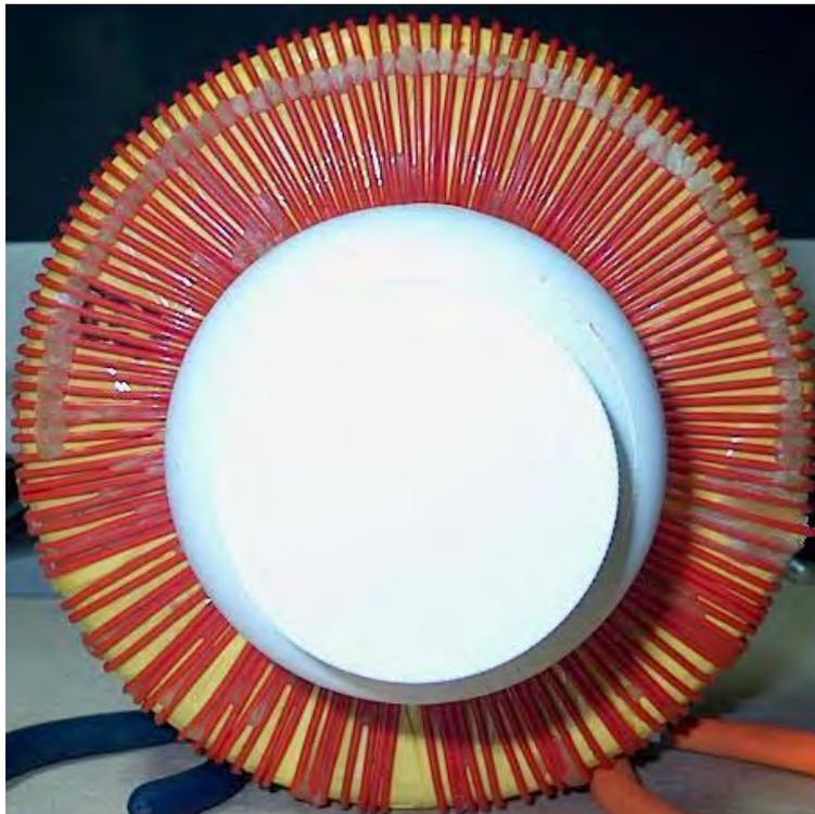
Quando os enrolamentos estão completos, corretamente espaçados e encaixados em cera de abelha, cada camada é finalizada com uma camada de fita. Bob diz: "Eu uso um único envoltório de fita isolante de PVC
