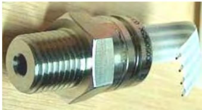
O pressostato é montado apenas em uma das tampas do tanque de pressão e a conexão elétrica do comutador é colocada entre o relé e o eletrolisador. Se a pressão do gás atingir o valor máximo de 30 psi. então a chave se abre, parando a eletrólise até que a pressão caia novamente:
