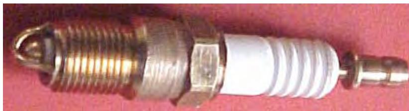
No entanto, este plug está longe de ser comum. O eletrodo central foi mudado de um poste cilíndrico para um domo hemisférico, cercado por quatro eletrodos arqueados, cada um dos quais sendo posicionado a uma distância constante do hemisfério. Isso permite uma área de ignição muito maior e resulta em um desempenho muito melhor.
