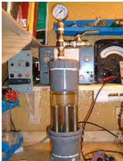
A eletrólise ocorre entre cada um dos tubos interno e externo. A figura acima mostra as bolhas começando a deixar os tubos depois que a energia é ligada. A figura abaixo mostra a situação alguns segundos depois, quando toda a área acima dos tubos está tão cheia de bolhas que fica completamente opaca:
