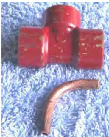
O tubo de cobre é então aquecido com uma tocha de gás de encanador e curvado muito lentamente e com cuidado para a forma mostrada acima. Algumas pessoas acham útil inserir um pedaço de material flexível adequado no tubo antes de iniciar a dobra - algo como o material de mola de aço enrolado usado para suportar cortinas de rede - pois isso ajuda a impedir que o tubo de cobre dobre quando é dobrado.
